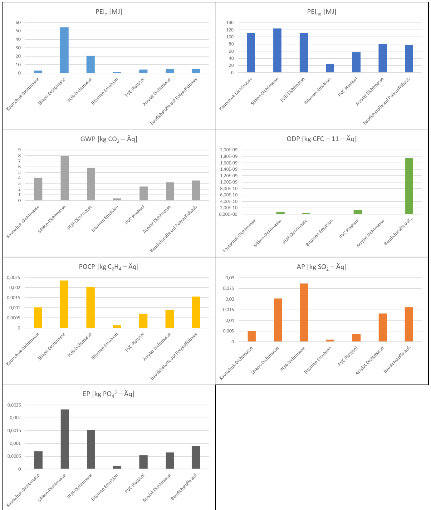
Abbildung 63: Vergleich der Umweltwirkungen (PEI e , PEI ne , GWP, ODP, POCP, AP, EP) von Dichtmassen
