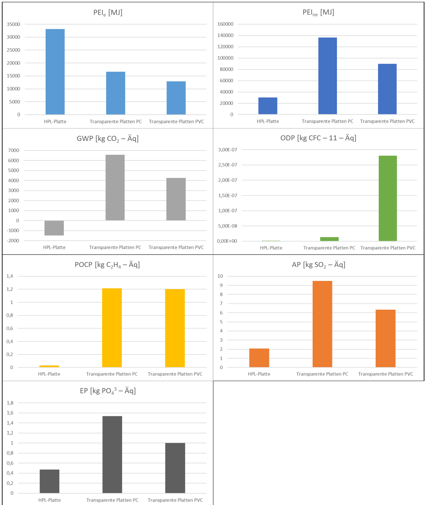
Abbildung 61: Vergleich der Umweltwirkungen (PEI e , PEI ne , GWP, ODP, POCP, AP, EP) von elastischen Kunststoffplatten
