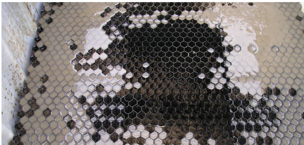
Abbildung 1: Teilweise verstopfte Füllkörper nach mehrtägiger Besprühung mit Belebtschlamm
