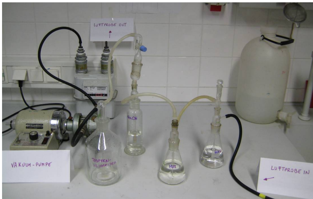
Abbildung 5: Aufbau der Abluftbeprobung
