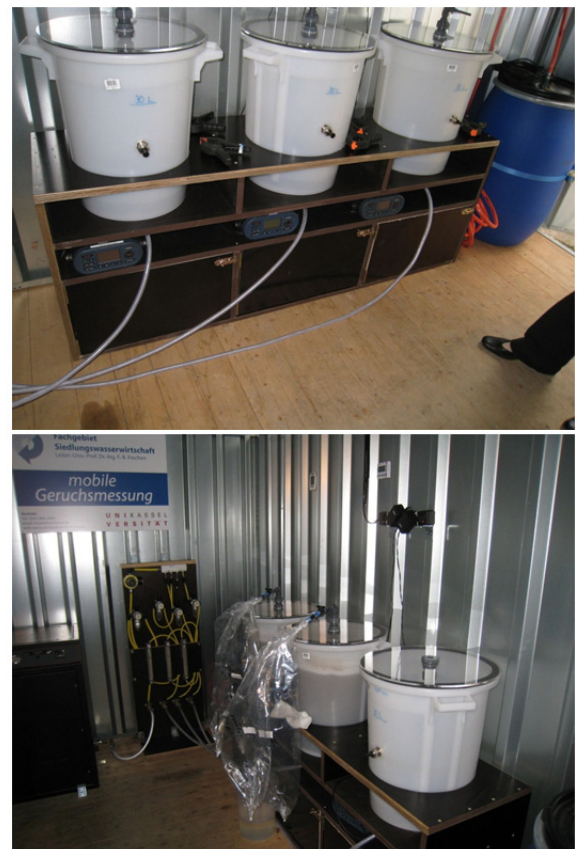
Abbildung 7: GEP-Testreaktor (links), 3 Reaktoren mobil im Anhänger (rechts)
