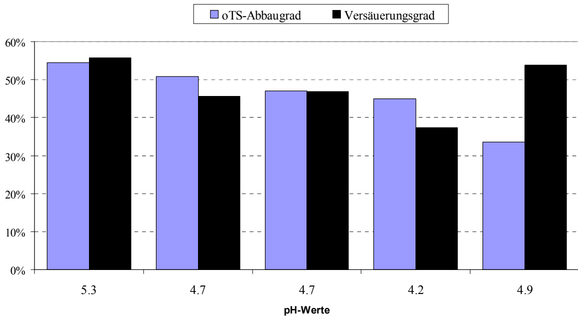
Abbildung 29: Versäuerungsgrad und oTS-Abbaugrad im Versäuerungsreaktor LV1 in Abhängigkeit vom pH-Wert (Ergebnisse aus den bilanzierten Versuchszeiträumen)
