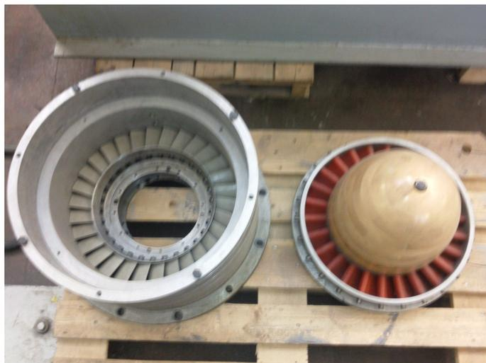
Abbildung 5.2.: Beschau felung des Prüfstandes
