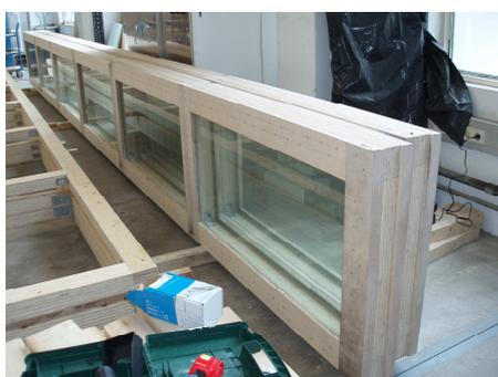
**Abbildung 54:** Zwei fertige Schubfeldträger
