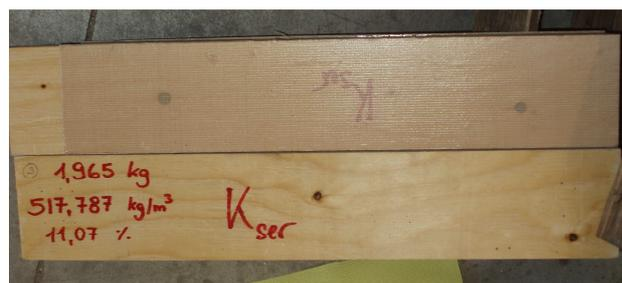
Abbildung 14: Mit Teflonfolie beklebtes und unbeklebtetes Probesteile
