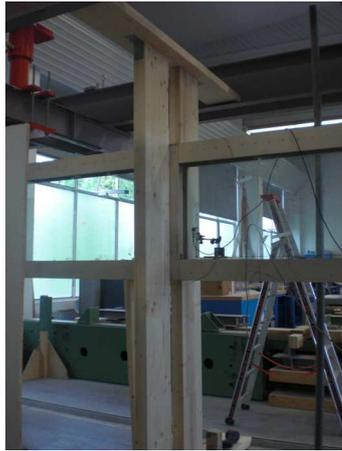
**Abbildung 61:** Holzkonstruktion in der Trägermitte zur Sicherung gegen Kippen
