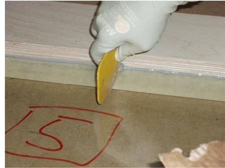
**Abbildung 38:** Entfernung des überschüssigen Acrylats mit einer Spachtel
