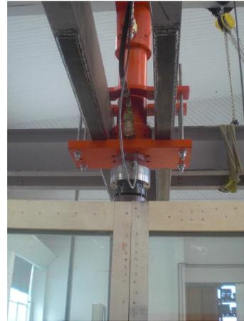
**Abbildung 62:** Druckzylinder, angreifend im Drittelpunkt auf den Träger
