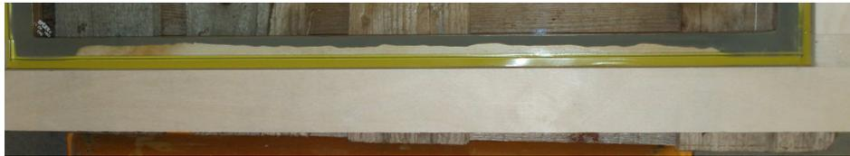
**Abbildung 44:** Fehlstelle in der Schubverklebung (Montageklebeband in gelb, Acrylat in grau)
