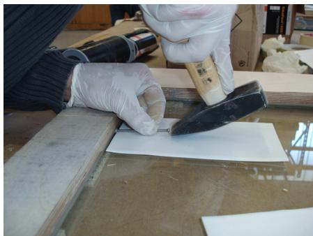
**Abbildung 45:** Anbohren der Schubverklebung
