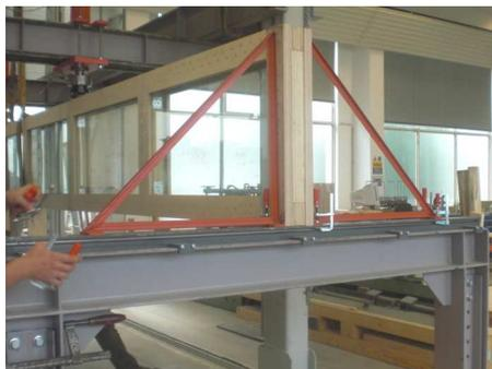
**Abbildung 59:** Stahl dreiecke am Auflager zur Sicherung gegen Kippen
