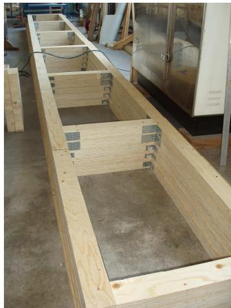
**Abbildung 48:** Fünf übereinandergestapelte Rahmen für Versuchsträger, die untersten drei davon für Schubfeldträger
