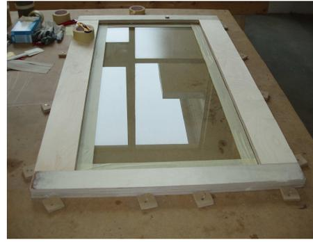
**Abbildung 34:** Um die Glasscheibe mit Klebeband angeordnete und bereits fixierte Koppelleisten, bereit zum Verpressen der Klebefugen
