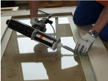
**Abbildung 37:** Verfüllung der Schubklebefuge mit Acrylat
