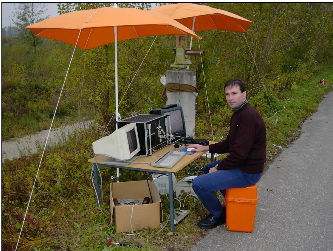
Abb. 7-3: Versuchsaufbau: Steuerrechner, Videotheodolit (Photo: Dr. Retscher)
