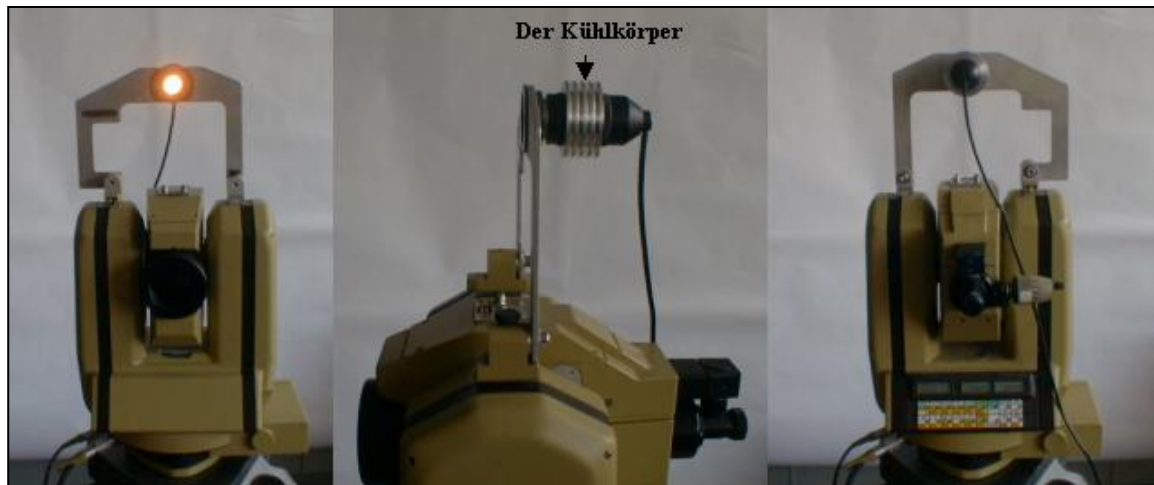
Abb. 4-8: Aufgeschraubter „Bügel mit Lampe“ auf dem Videotheodolit
