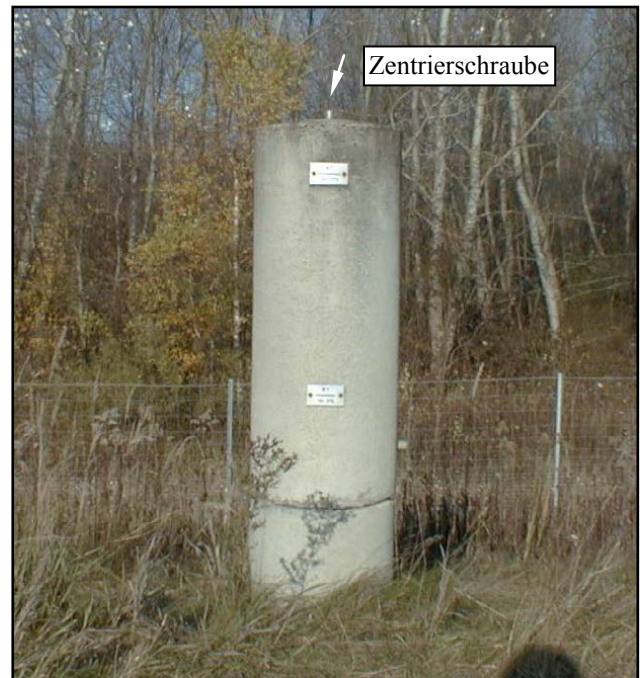
Abb. 7-46: Messpfeiler mit Zentrierschraube
