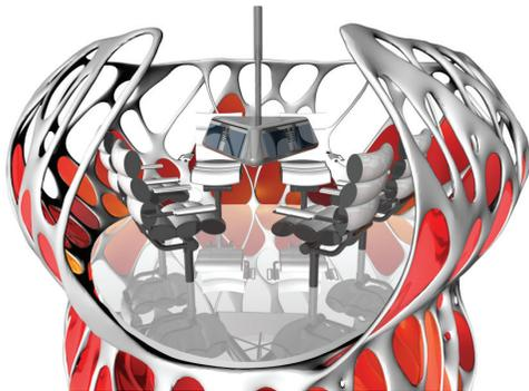
**Der Kontrollraum** bietet Platz für 6 Personen. Die Konsole in der Mitte verfügt über 6 Einzelmonitore und Steuerungselemente. Die Konsole kann bei Bedarf durch eine Hydraulik nach oben gezogen werden. Der Raum kann ebenfalls zur barrierefreien Kommunikation genutzt werden.
