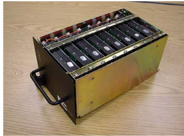
Abb. 2-4: Mark V Prototypgehäuse und „8-pack“ Modul ( http://web.haystack.mit.edu/mark5/ ).
