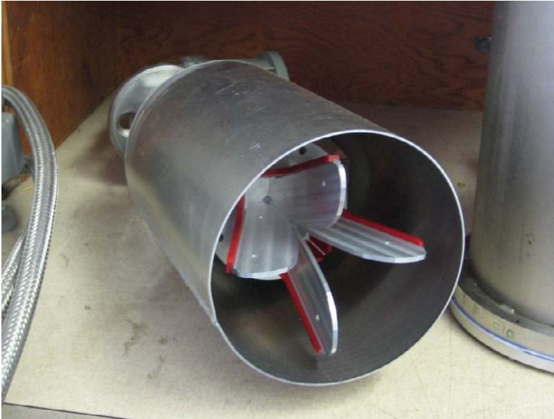
Abb. 3-2: ETS-Lindgren quad-ridge Breitband Feed-Horn (ETS-Lindgren, 2007) in einem Hitzeschild verbunden mit einem 15 K Tieftemperaturkühler (Kühlflüssigkeitsbehälter rechts im Bild) (Foto aus Behrend et al., 2008).
