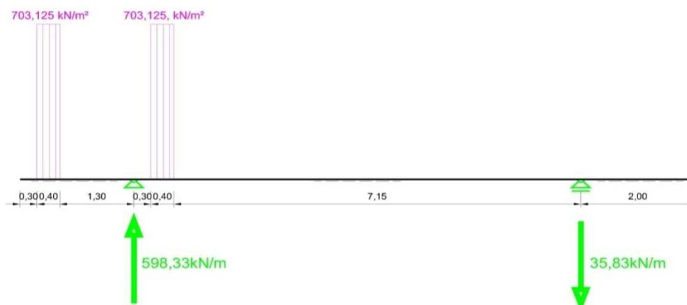
Abbildung 11-21: 75% der Auflagerreaktion der Achslast Fahrspur 1 aus LM-1
