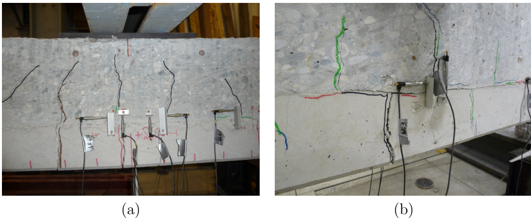
Abbildung 6.41: Versagensart : (a) VK3: Biegerisse (b) VK4: Biegerisse u. Risse entlang der Verbundfuge
