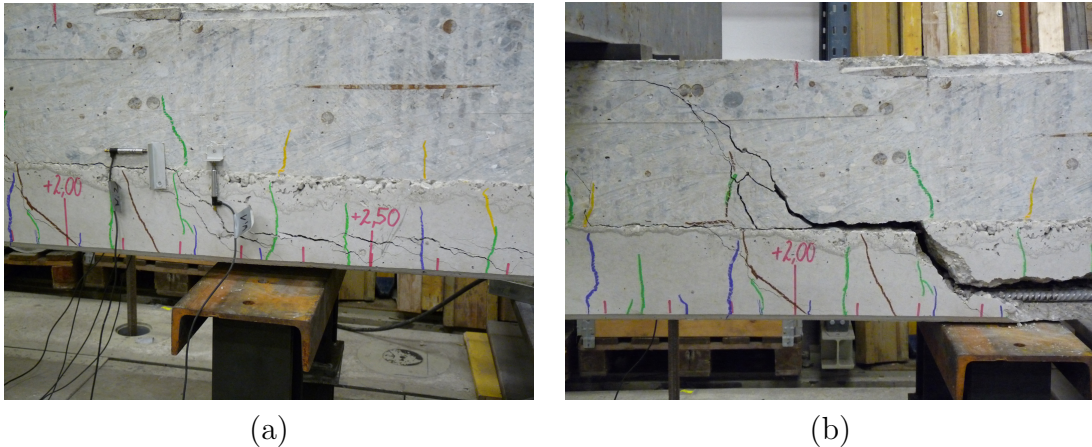
Abbildung 6.27: Versagensart - Biegeschubbruch VK1: (a) kurz vor Bruchlast (b) Bruch
