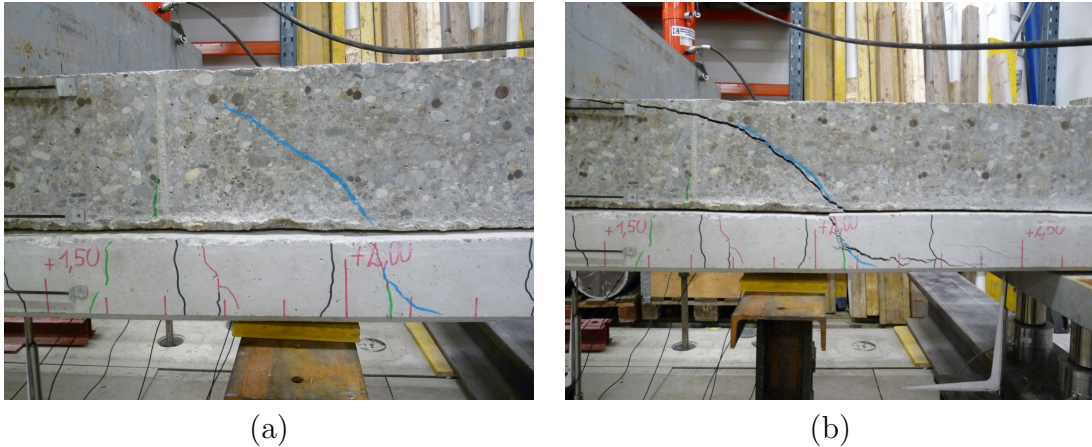
Abbildung 6.28: Versagensart - Biegeschubbruch VK2: (a) kurz vor Bruchlast (b) Bruch
