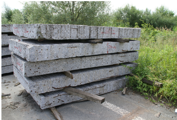
Abbildung 4.1: 50 Jahre alte Betonplatten von der Baron Schwarz-Park Brücke (1962)
