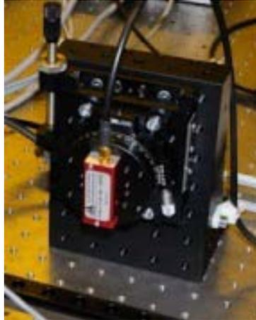
Abbildung 42: Befestigungs und Montagevorrichtung des AOM im Strahlengang der M3D.
