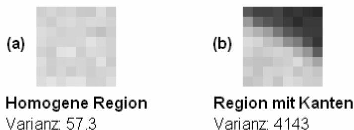
Abb. 16: Kantendetektion durch Berechnung der Varianz. (a) Varianz einer homogenen Region. (b) Varianz einer Region mit Kanten.
