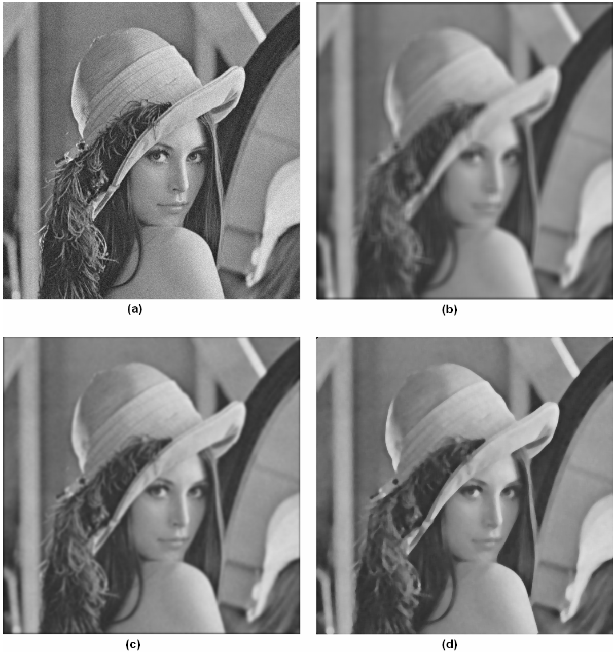
Abb. 12: Vergleich traditioneller Glättungsverfahren. (a) Verrauschtes Originalbild. (b) Ergebnis nach Anwendung eines 7x7 Mittelwert Filters. (c) Ergebnis nach Anwendung eines 11x11 Gauß Filters, \sigma = 2.00 . (d) Ergebnis nach Anwendung eines 7x7 Median Filters.
