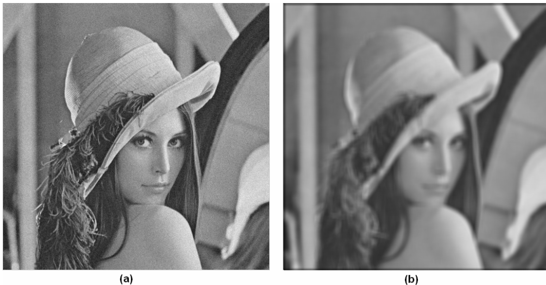
Abb. 4: Glättung mit dem Mittelwert Filter. (a) Verrauschtes Originalbild. (b) Ergebnis nach Anwendung eines 11x11 Mittelwert Filters.
