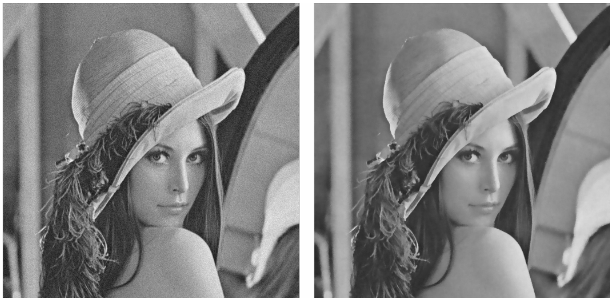
Abb. 1: Glättung eines verrauschten Bildes (links) mit dem kantenerhaltenden Bilateral Filter. Im geglätteten Bild (rechts) bleibt die Kantenschärfe weitgehend erhalten.
