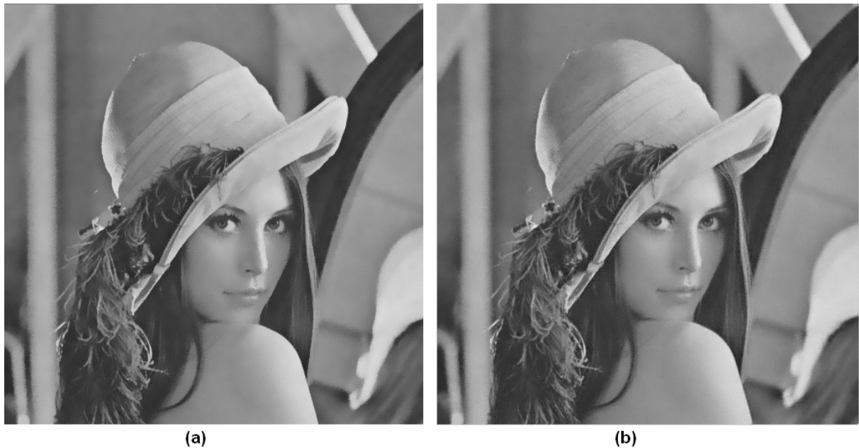
Abb. 18: Vergleich zwischen Bilateral Filter und Guided Image Filter. (a) Ergebnis nach Anwendung eines 11x11 Bilateral Filters. (b) Ergebnis nach Anwendung eines 9x9 Guided Image Filters, \varepsilon = 0.004 .
