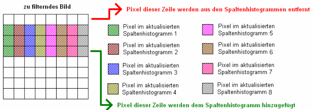
Abb. 34: O(1)-Algorithmus zur Berechnung des Medians. Schritt 7: Aktualisierung der Spaltenhistogramme in einem 8x8 Bild bei Wechsel auf die 3. Bildzeile. Radius des Median Filters: 1.
