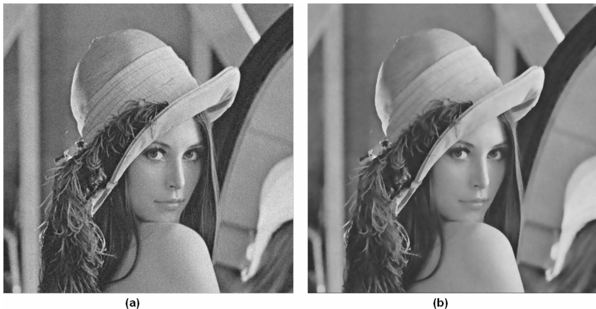
Abb. 13: Glättung mit dem Bilateral Filter. (a) Verrauschtes Originalbild. (b) Ergebnis nach Anwendung eines 11 \times 11 Bilateral Filters.
