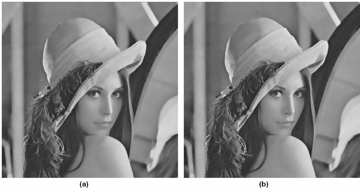
Abb. 14: Vergleich zwischen Bilateral Filter und Bilateral Median Filter. (a) Ergebnis nach Anwendung eines 11x11 Bilateral Filters. (b) Ergebnis nach Anwendung eines 11x11 Bilateral Median Filters.
