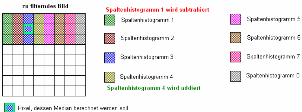
Abb. 33: O(1) -Algorithmus zur Berechnung des Medians. Schritt 4: Aktualisierung des Kernel-Histogramms in einem 8 \times 8 Bild bei Wechsel zur umrandeten Position. Radius des Median Filters: 1.
