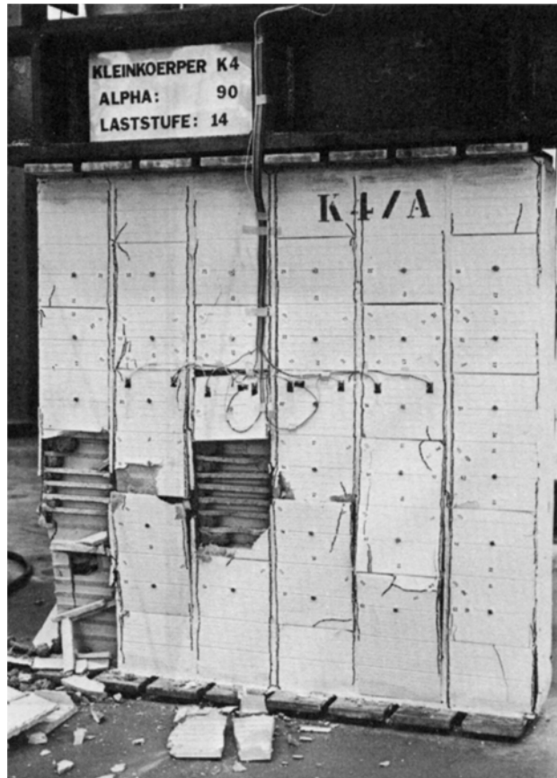
Bild 89: Bruchbild an der getesteten Wand im Labor, entnommen aus [35]
