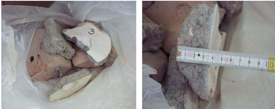
Bild 178: Bohrkern 3, Mauerputz 3,5 cm, entnommen aus [137]
