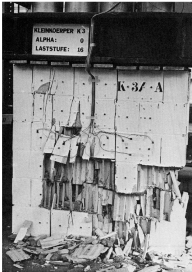
Bild 79: Bruchbild an der getesteten Wand im Labor, entnommen aus [35]
