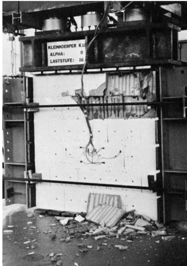
Bild 129: Bruchbild an der getesteten Wand im Labor, entnommen aus [35]
