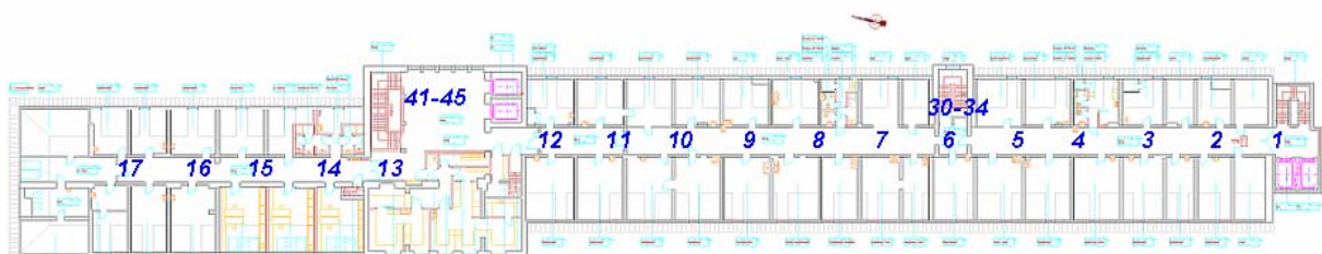
Bild 170: Messanordnung der Sensoren im 5.OG
