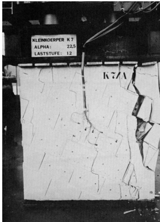
Bild 109: Bruchbild an der getesteten Wand im Labor, entnommen aus [35]
