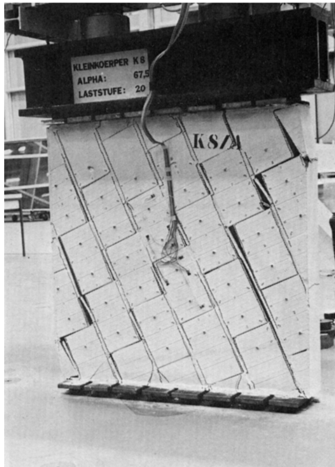
Bild 119: Bruchbild an der getesteten Wand im Labor, entnommen aus [35]
