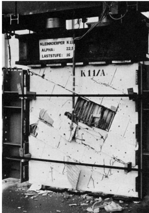
Bild 139: Bruchbild an der getesteten Wand im Labor, entnommen aus [35]
