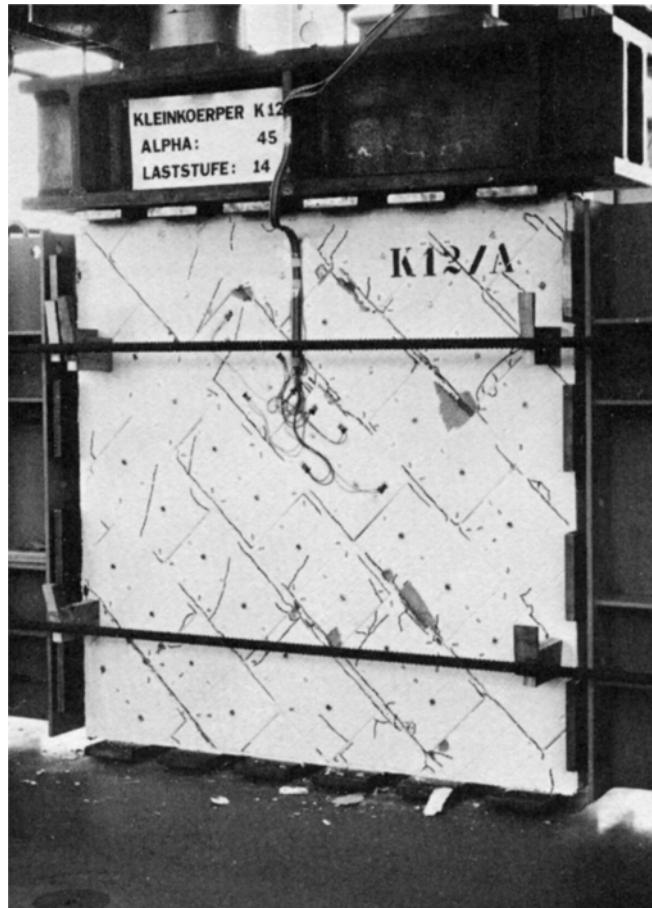
Bild 149: Bruchbild an der getesteten Wand im Labor, entnommen aus [35]
