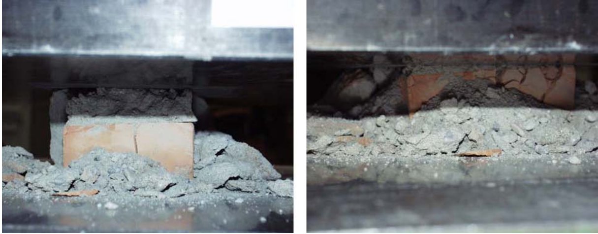
Bild 180: Abdrückversuch des Mörtels, entnommen aus [137]
