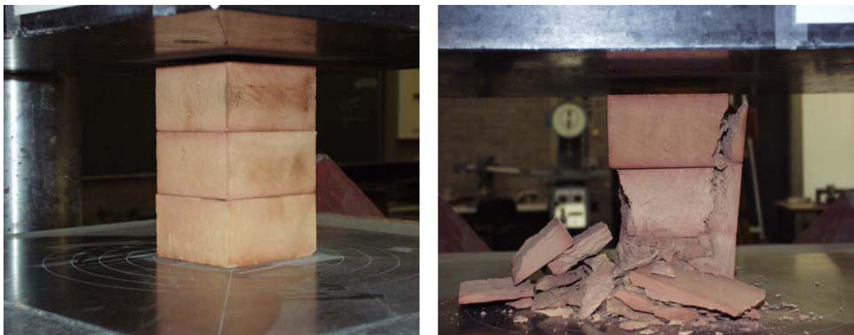
Bild 179: Abdruckversuch der Ziegelsteine, entnommen aus [137]
