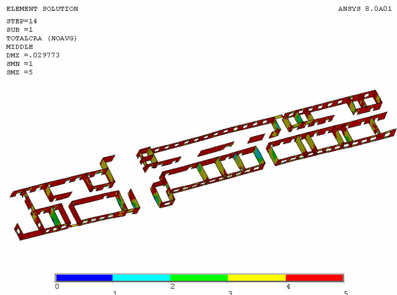
Bild 185: Rissmuster im EG
