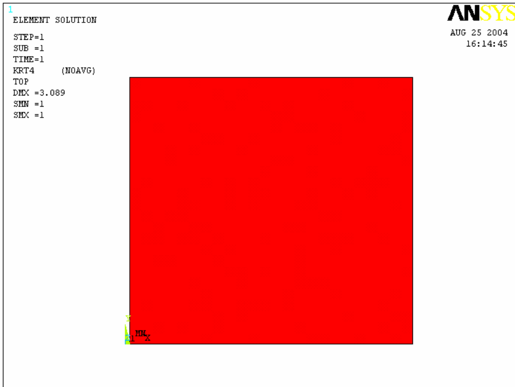
Bild 87: Versagensbild zufolge Kriterium 4; Gleiten entlang der Lagerfuge
