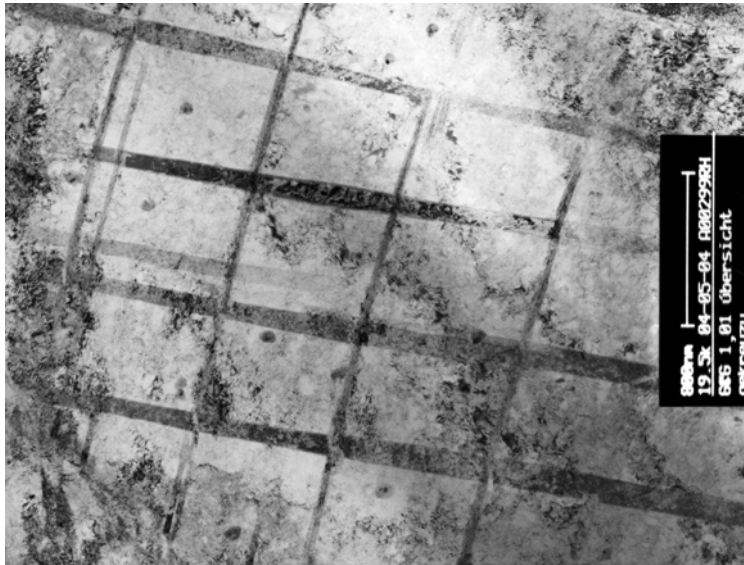
Abb.5.1.21: 1.4310 1.01 mm: HF, Übersicht, regelmäßige Anordnung von Austenit Zwillingen
