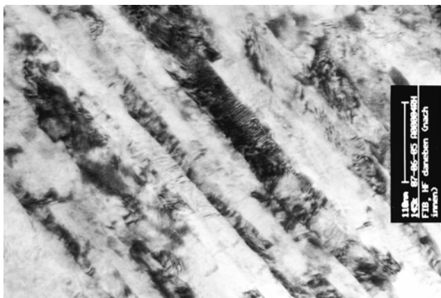
Abb.5.1.51: 1.4310 0,27 mm: HF, Ziehgefüge an der Drahtoberfläche
