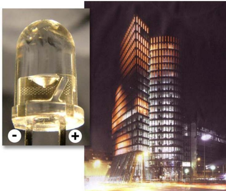
Abb. 47: LED in einer Makroaufnahme (links) und Abb. 48: Uniqa-Tower in Wien mit einer Medienfassade aus 40.000 LEDs.
