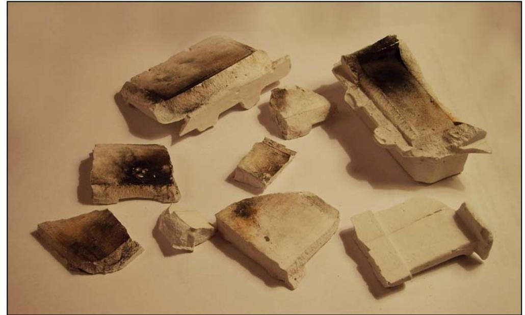
Abb. 50 (oben): Trümmerteile eines gesprengten Flakturmmodells aus Gips
