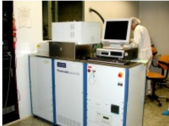
Abbildung 4.1: Die am Zentrum für Mikro- und Nanostrukturen der Technischen Universität Wien installierte RIE/ICP-Anlage Oxford Plasmalab 100
