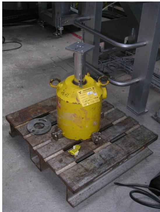
Abbildung 3.13: Transport der bestrahlten Probe zum Instrument SANS-I in massiver Pb-Abschirmung
