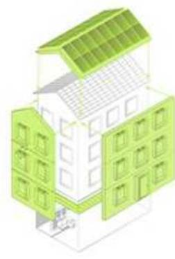
Abbildung 24: Serielle Vorfertigung der Bauteile [34]
