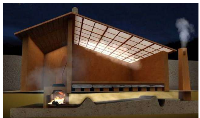
Abb.41 Rekonstruktion eines Ondol-Systems in einem Gewächshaus
