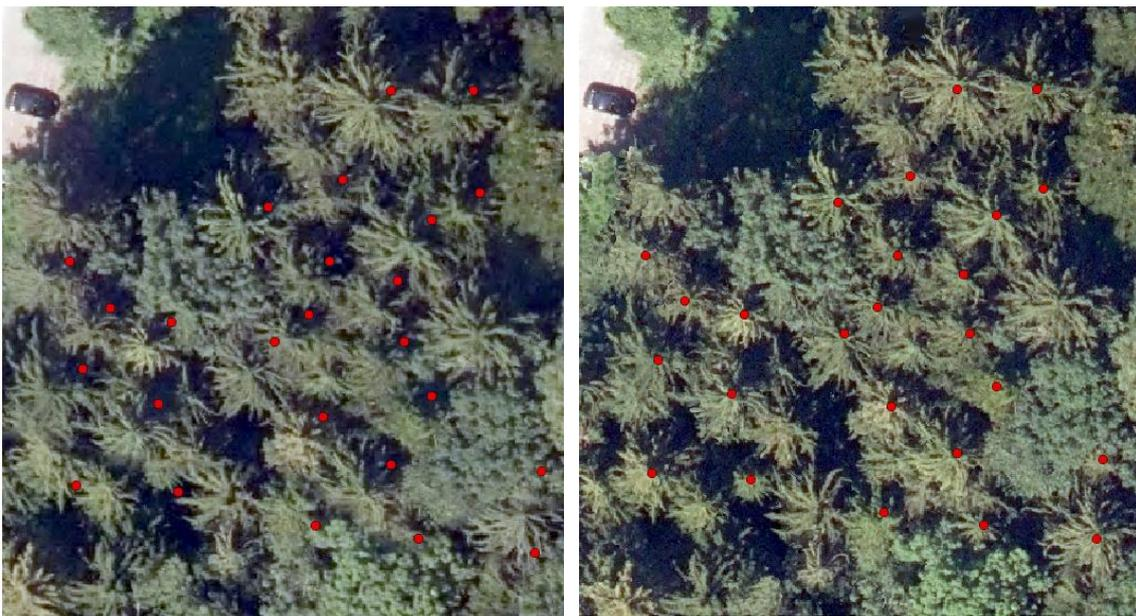
**Abbildung 3.1:** Vergleich von Orthophoto (links) und True Orthophoto (rechts), mit den detektierten Baumspitzen in Rot dargestellt
