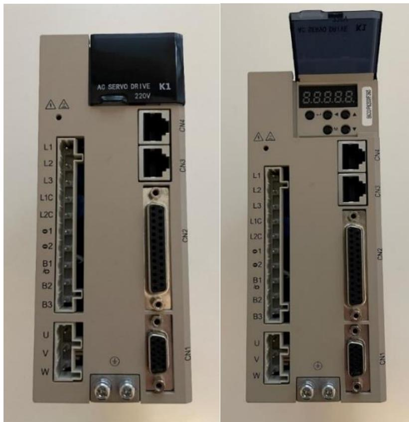
Abbildung 33: Servo-Regler MG-K1AS15CA
