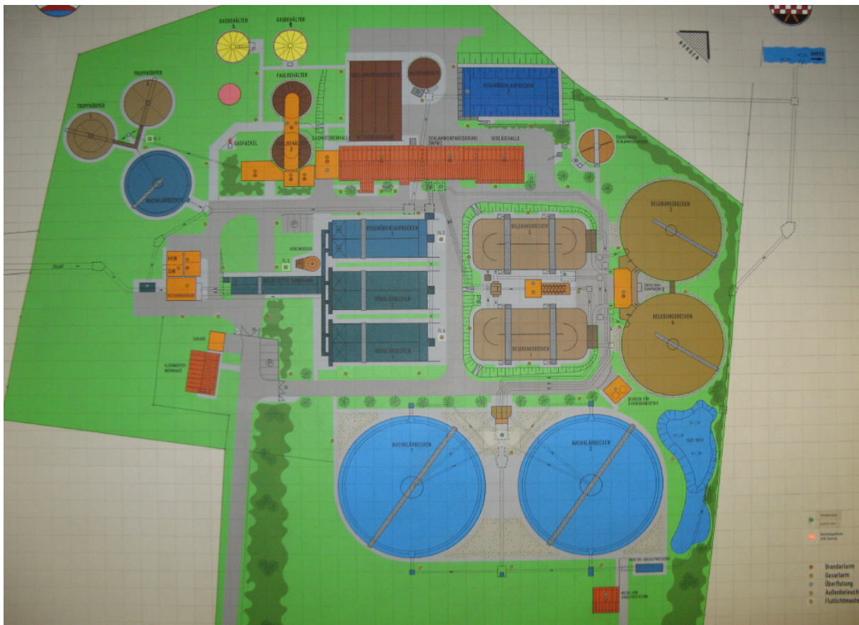
Abbildung 1: Lageplan der Kläranlage Fürstenfeldbruck
