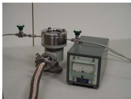
Abbildung 4.6: Vakuumkammer mit Druckmessgerät
