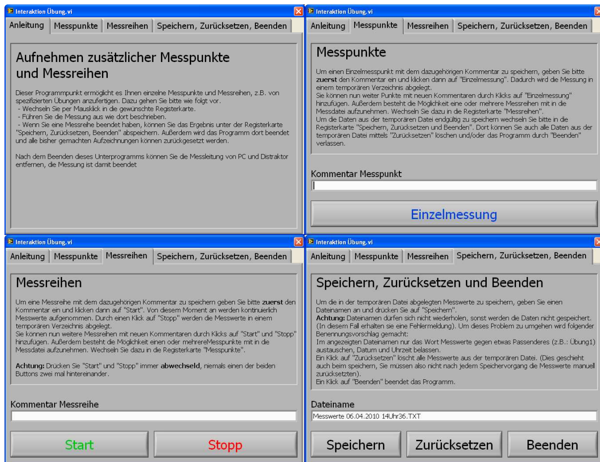
Abb 34: Die vier Registerkarten des SubVis „Interaktion Übung“ erlauben es dem Nutzer Messdateien nach belieben anzufertigen. Jede Registerkarte enthält eine umfassende Anleitung. Nicht abgebildet ist die fünfte Registerkarte, in welcher die aktuellen Messdaten graphisch dargestellt werden.
