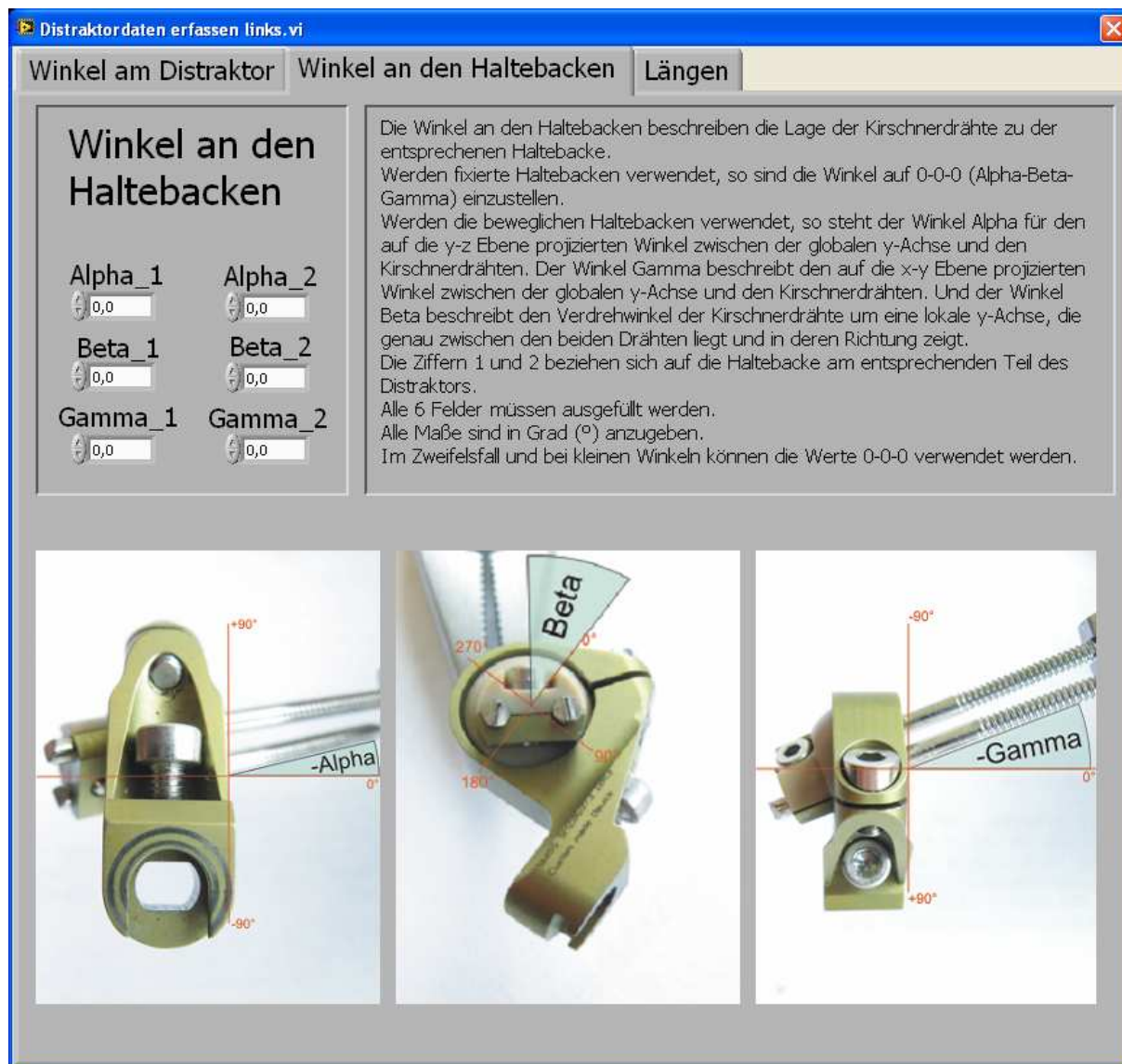
Abb 32: Abfrage der Winkel an den Kirschnerdrähten. Die umfassende Erklärung und zweckmäßige Bebilderung soll die korrekte Eingabe erleichtern.
