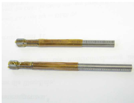
Abb 19: Zwei Gewindestangen nach dem Kleben, alle vier DMS pro Stab wurden appliziert.
