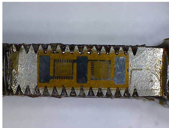
Abb 21: DMS auf Stab 2, 45mm Länge, Stabseite A
