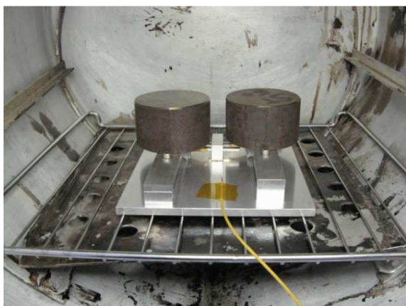
Abb 18: Gewindestangen im Ofen. Die Rundstahlstücke werden benötigt, um den erforderlichen Druck an den Klebestellen aufzubringen.
