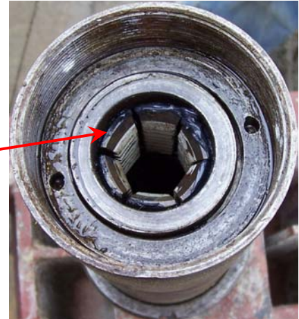
Abb. 27 Gezahnte Keilbacken eines zerlegten Hebers (Eigenfoto)
