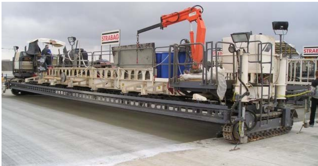
Abb. 13 Gleitschalungsfertiger SP 1600 der Firma WIRTGEN [2.1]
