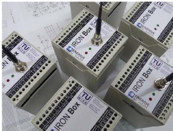
Abbildung 1.1: Design der DSM-Interface-Einheit IRON Box (aus [9: S.104])
