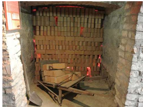
Abb. 47: Setzen der Rohlinge in die Kammer (Wiener Zieglmuseum)
