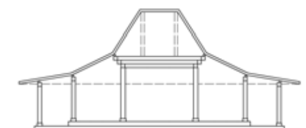
Abb. 39 System-Darstellung des joglo-Daches mit zwei umgebenden Säulenkränzen, Zeichnung frei nach (Tjahjono & Miksic, 1998)
