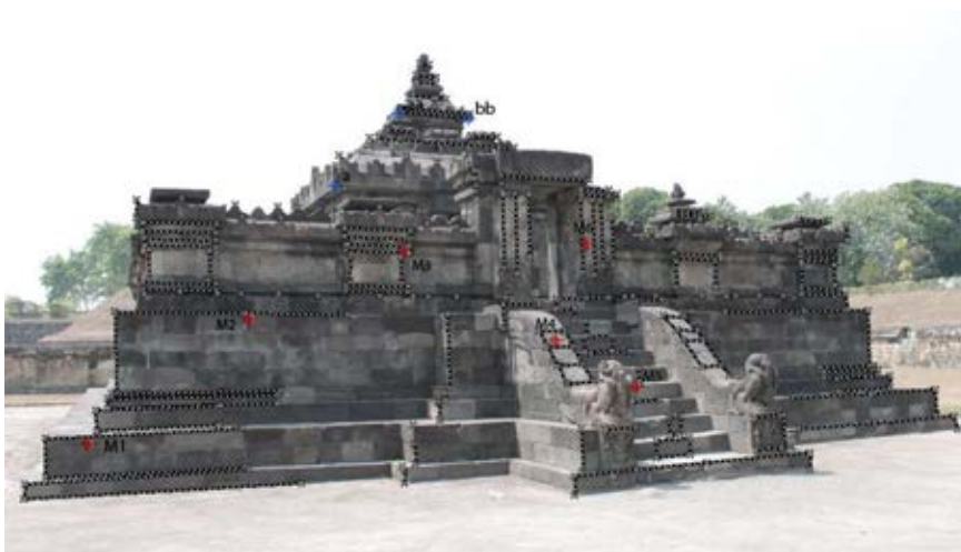
Abb. 372 + 373 Candi Sambisari, oben Nordansicht, unten Westansicht, Darstellung der eingelesenen Messpunkte, die rot markierten Punkte stellen gemessene Gebäudebereiche dar, die blau markierten Punkte wurden über manuelle Eingabe in die Software errechnet
