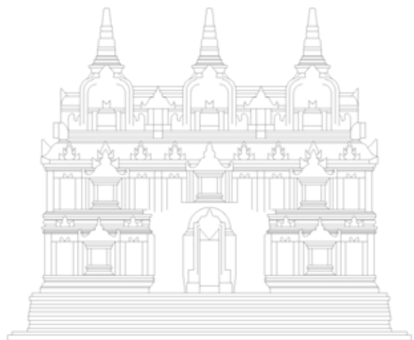
Abb. 334 Candi Sari, Ansicht Ost, die Grafik zeigt den Entwurf für die Rekonstruktionsarbeiten am Bauwerk, adaptierte Plangrafik [Quelle: Anom, 1997]
