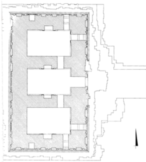
Abb. 333 Candi Sari, der Grundriss zeigt den heute rekonstruierten Zustand des Tempels [Quelle: Dumarcay, 1981]
