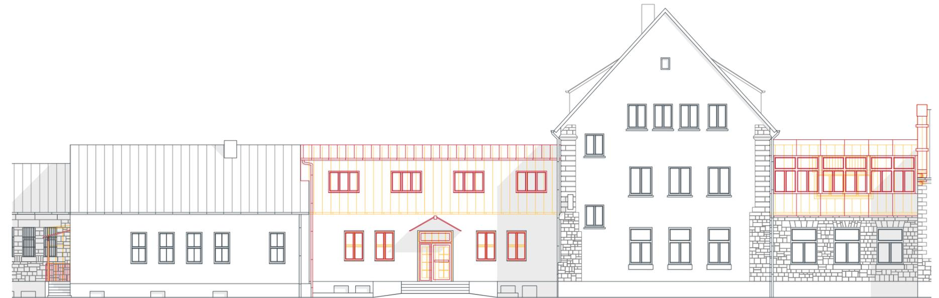
Abb. 138: Veränderungen an der Güterabfertigung, Süd-West-Fassade, 1958-1998 M 1:200
