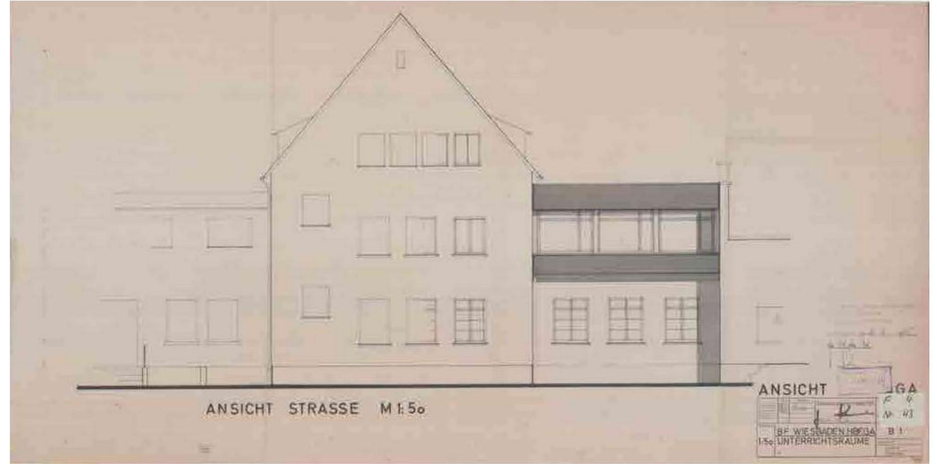
Abb. 388: Güterabfertigung: Plan mit Ansicht der Süd-West-Fassade mit dem neuen Geschossausbau, 1975
