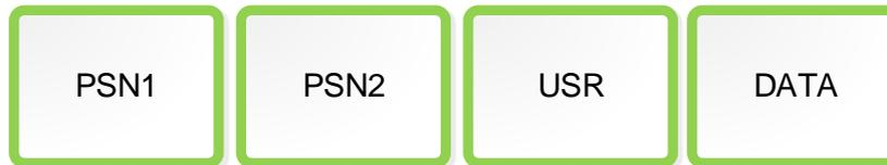
Abbildung 13: Aufbau eines Verbindungssatzes
