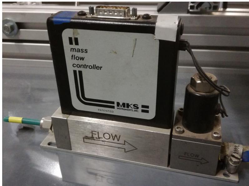
Abbildung 4.16: Massflowcontroller Type 1559A-200L-SV von MKS-Instruments
