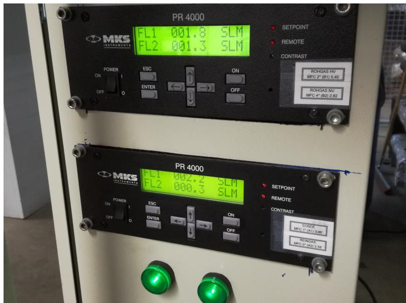
Abbildung 4.17: Steuer- und Regelungseinheit PR4000F für MKS Massflowcontroller
