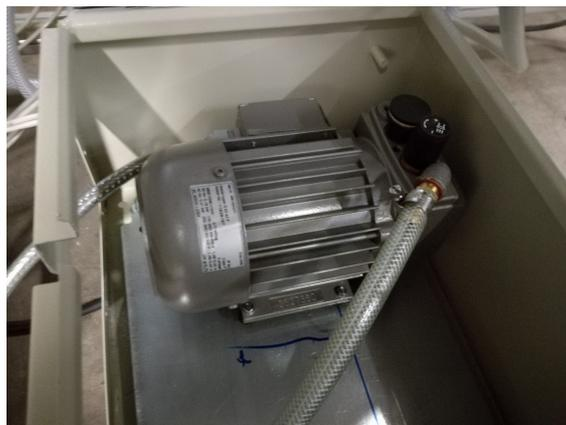
Abbildung 4.13: Drehschieberpumpe VT 4.4 mit 2,1 kW
