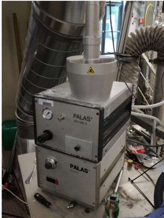
Abbildung 4.9: Staubdosierer BEG 1000D der Firma Palas
