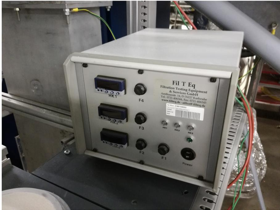
Abbildung 4.5: Steuerkasten für die Beheizung der Anlage
