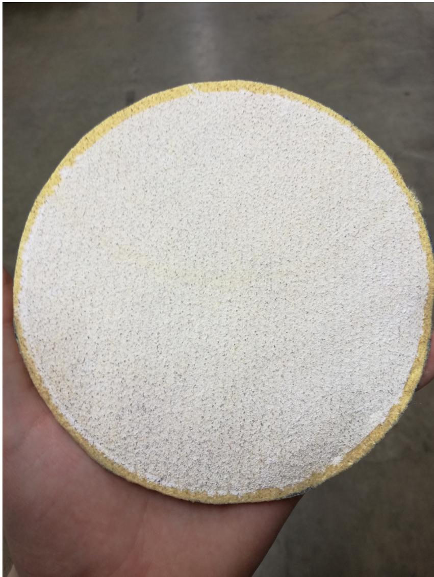
Abbildung 4.23: Bestaubtes Nadelfilz nach dem Einsatz im Prüfstand
