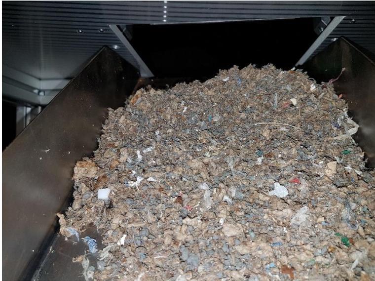
Abbildung 35: Reststoffpartikel auf der Rutsche
