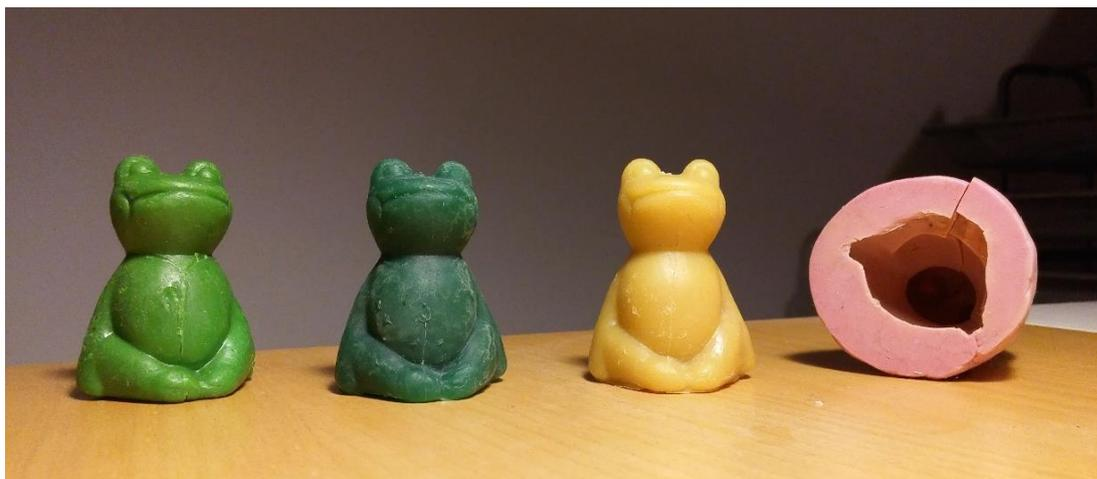
Abbildung 21, (v. l. n. r.) Ursprungsform (Seife), Guss 1 (Epoxidharz), Guss 2 (Polyurethan), Matrize (Eigene Darstellung)
