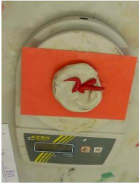
Abbildung 13, Silikon-Knetmasse (grau) und Härterpaste (rot) (Eigene Darstellung)
