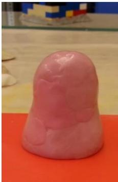
Abbildung 17, fertige Matrize, Aushärtezeit: 2-5 Stunden (Eigene Darstellung)
