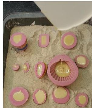
Abbildung 20, Gießen der Matrizen mit Polyurethan (Eigene Darstellung)
