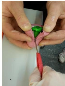
Abbildung 18, die Ursprungsform kann aus der Matrize geschnitten bzw. gelöst werden (Eigene Darstellung)
