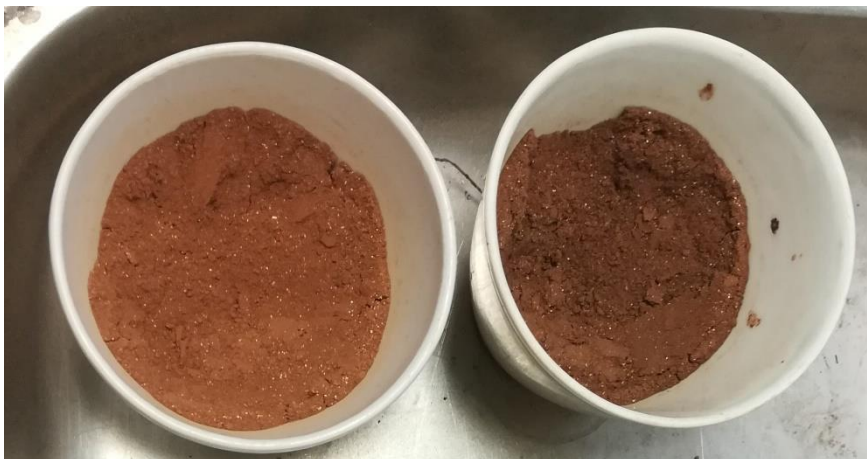
Abbildung 6: Links: bereits abgekühlte Probe Rechts: Probe, die gerade aus dem Ofen kam
