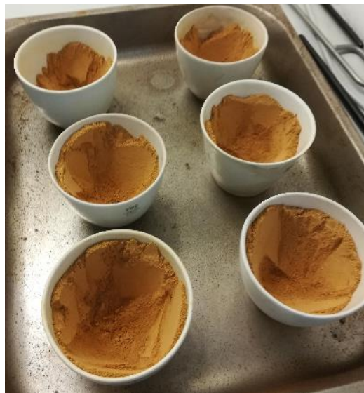
Abbildung 4: Foto der Tiegel, die mit ca. 20 g gemahlener Filterkuchenprobe befüllt wurden, welche anschließend an den Rand des Tiegels gepresst wurde, um die Schichtdicke möglichst gering zu halten
