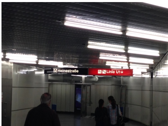
(a) Freistrahkende Lichtleisten quer zur Hauptgehrichtung erzeugen höhere Blendungen
