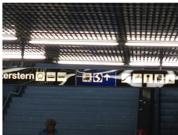
Abbildung 84: Reflexblendung auf Hinweisschildern
