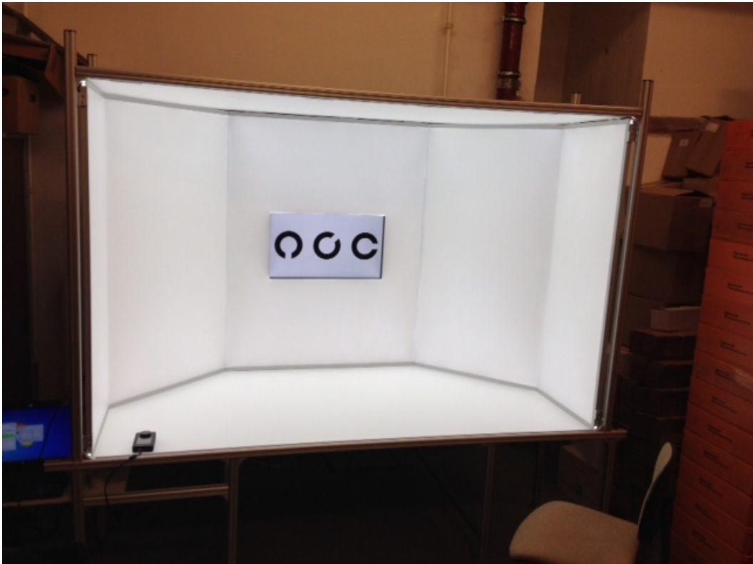
Abbildung 30: Original Versuchsaufbau für die beleuchtungsabhängigen Sehtests
