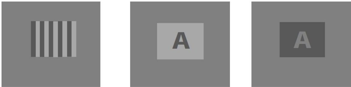
Abbildung 69: Beispiel für eine geringe Leuchtdichteunterschiedsschwelle (die graue periphere Fläche ist das Umfeld und liegt von der Helligkeit zwischen den Testflächen/-objekten)
