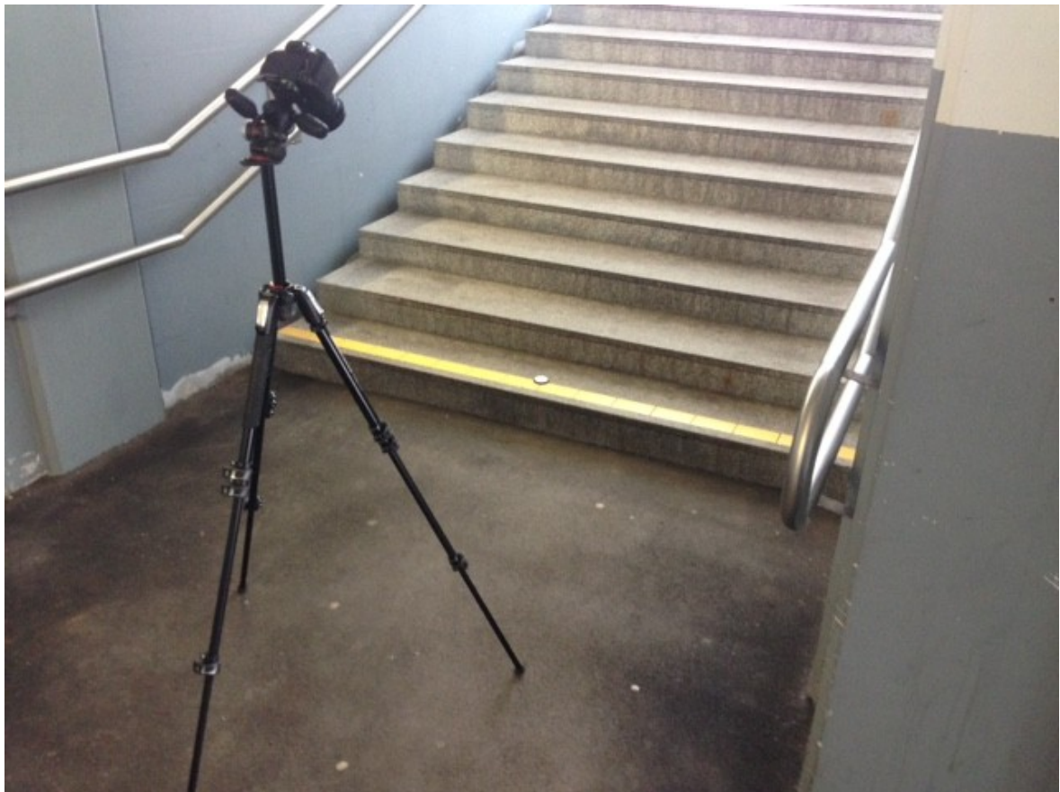
Abbildung 98: Mögliche Messanordnung für die Bestimmung der Leuchtdichten und Reflektionswerte einer Stufenmarkierung Praxisrelevanter Messwinkel für diese Anwendung ist 45^\circ
