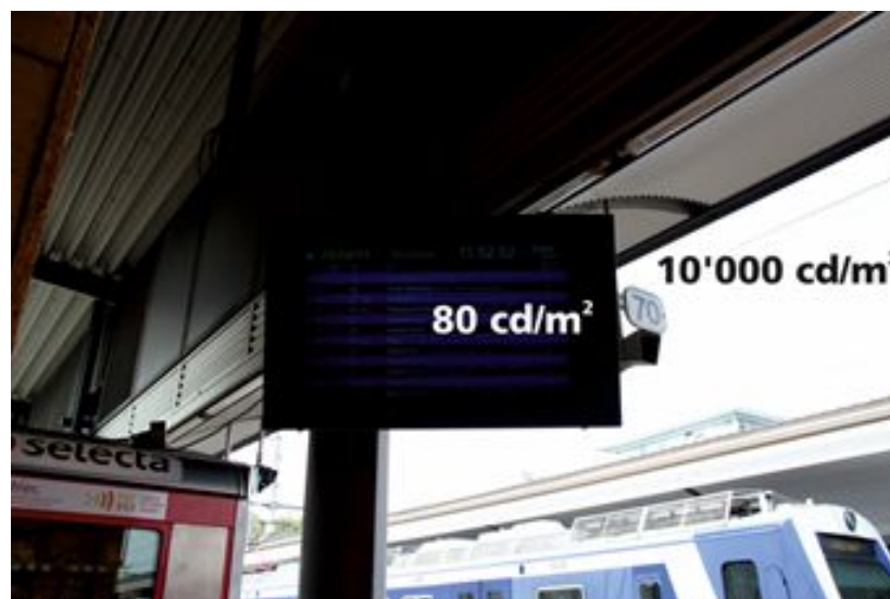
Abbildung 71: ÖBB Monitor unter Tageslichteinfluss; Der Kontrast und somit die Erkennbarkeit sind deutlich reduziert
