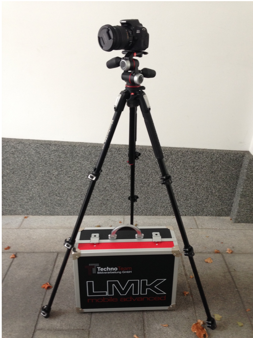
Abbildung 101: Mobile Leuchtdichtekamera „LMK mobile Advanced“ der Fa. Techno-Team
