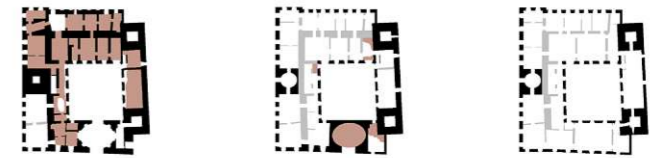
Grafik: Bestandsdecke Erdgeschoß/ Obergeschoss1/ Obergeschoss2
