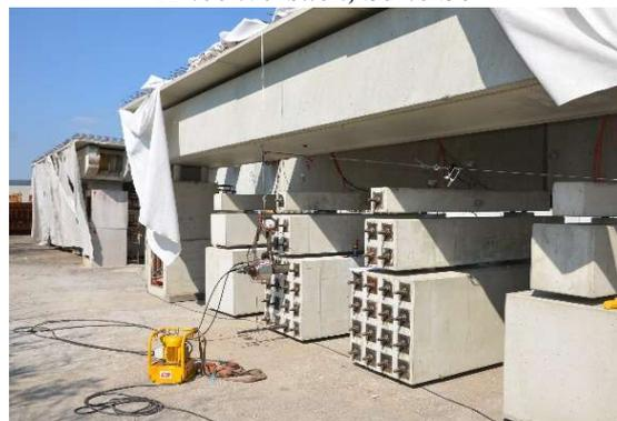
Foto 8: Nachspannen der Betonkörper
