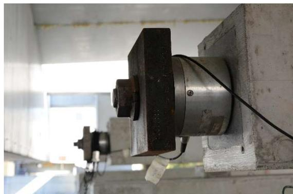
Bild 3.12: Kraftmessdosen an den kleinen Körpern der Serien S1 und S2
