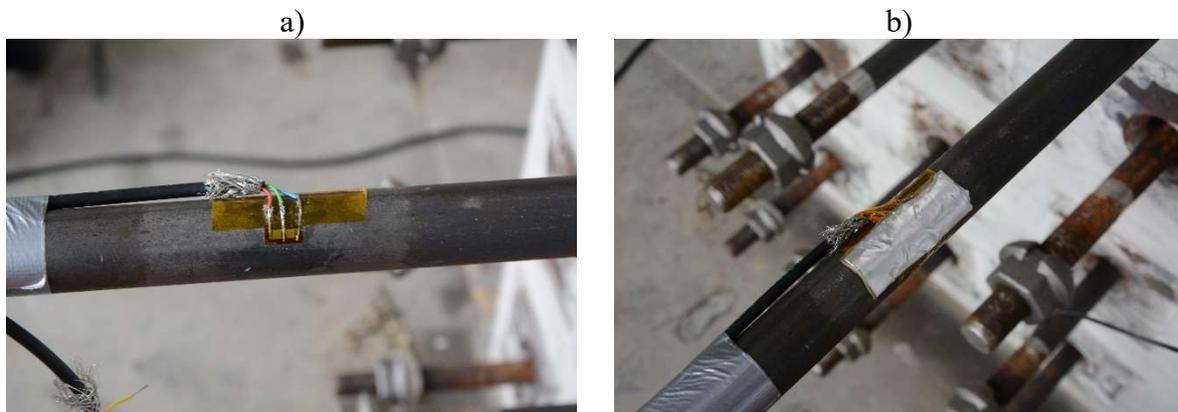
Bild 3.11/a und 3.11/b: Fotos von einem Dehnmessstreifen (DMS)
