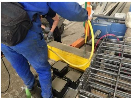
Foto 5: Vibration der Testkörper
