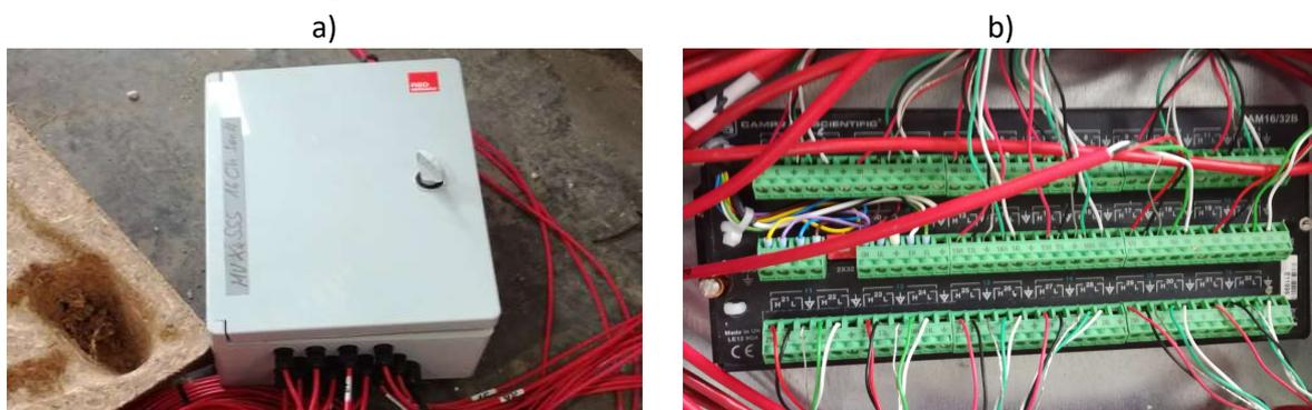
*Bild 3.7/a und 3.7/b: Verbindung der Schwingsaitensensoren mit dem Multiplexer*
