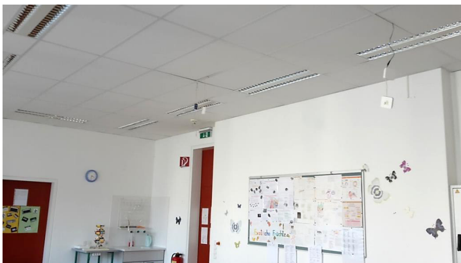
Abb. 2.4: Referenzraum Raum 253. Die Sensoren (von links nach rechts) RTR531 (blau), 11403 (weiß) und 11604 (weiß) machen sich unterhalb der Decke erkennbar. Deren Anordnung ist ca. 2,0m von der unbegrünten Innenwand, gegenüberliegend von der Fensterfront, und mit etwas Abstand von der abgehängten Decke.
