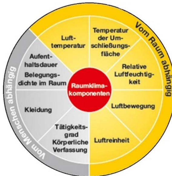
Abbildung 2 Die wichtigsten Einflussgrößen auf das vorherrschende Raumklima, welche in Parameter, abhängig vom Raum sowie vom Menschen, unterteilt sind. unverändert aus [12]. Des Weiteren weisen die Regelwerke DIN 1946-2:1994-01 [8]; ÖNORM EN ISO 7730:2006 05 01 [10] und ÖNORM EN 16798-3:2017 12 15 [11] in Bezug auf das Raumklima auf folgende Einflussfaktoren hin: Luft (Temperatur, Feuchte, Geschwindigkeit), Strahlung (Oberflächentemperaturen, Wärmestrahlung, kurzwellige Strahlung), Bekleidung, Aktivität, Aufenthaltsdauer und Außenklima. Wichtig sind genügend Licht sowie die Abwesenheit von Immissionen wie Lärm und Gerüche [12].
