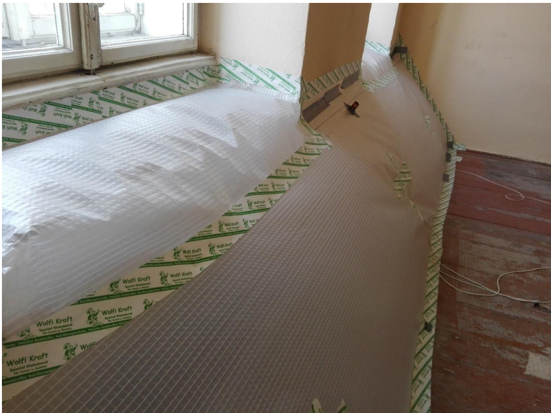
Abb. A.10: Aufblähen der Folie bei 10 Pa Druckunterschied, trotz einer Druckausgleichsöffnung
