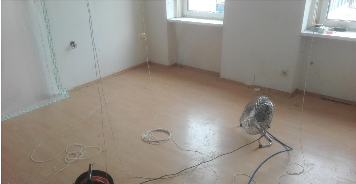
Abb. 3.3.2: Foto des Quellraums vor Messung 01, CO 2 -Einblasung durch den blauen Schlauch beim Ventilator, CO 2 -Sensoren im Raum hängend.
