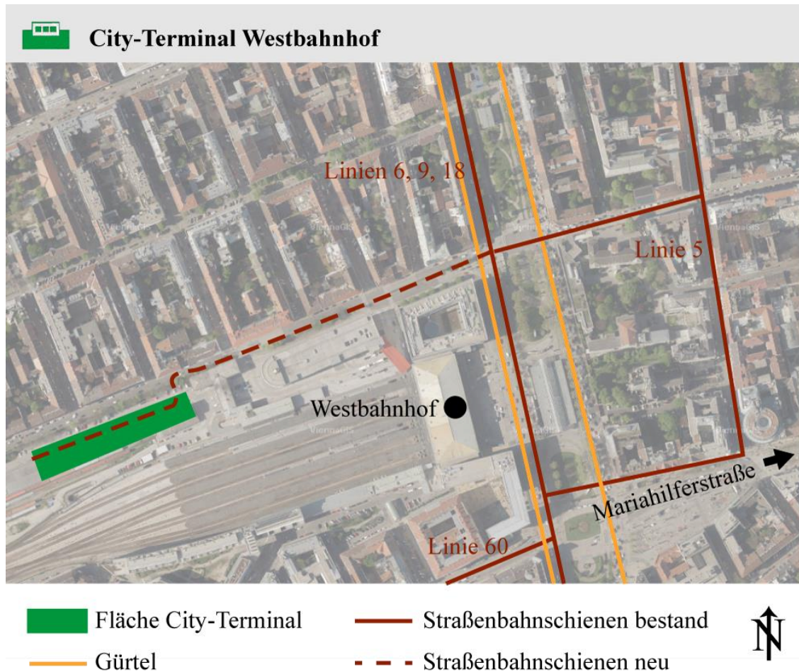
Abbildung 54: Schematische Plandarstellung und Anbindung des City-Terminals Westbahnhof
