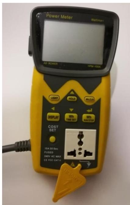
**Abb.9 Messgerät Wattman HPM 100A**
