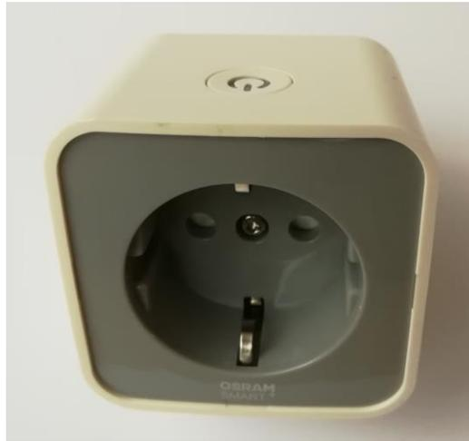
**Abb.39 Smart-Schukozwischenstecker Osram Smart+**
