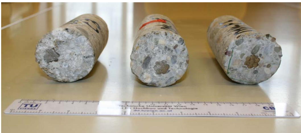
Abbildung 8.11: Bohrkerne (H: 150 mm, Ø 50 mm) mit Spannkabel in der Mitte
