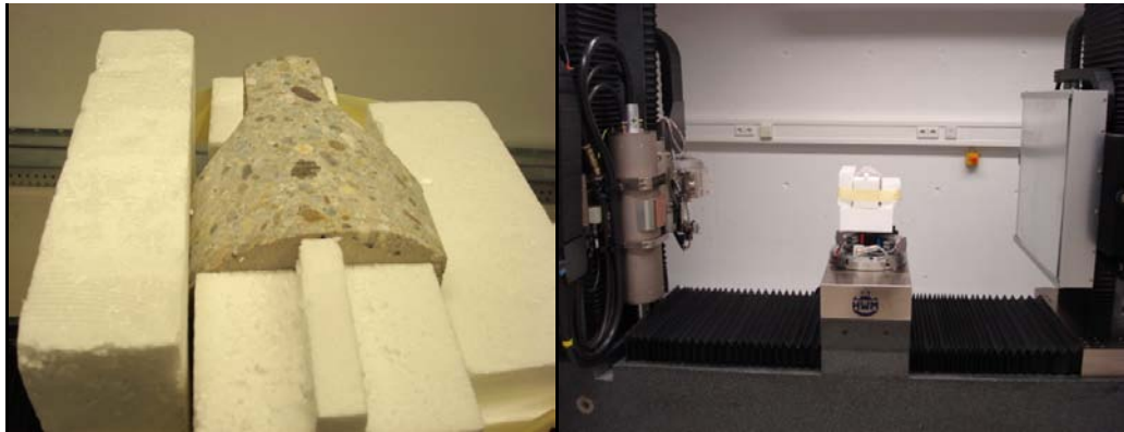
Abbildung 8.13: Probenfixierung (links) und Probenpositionierung (rechts)
