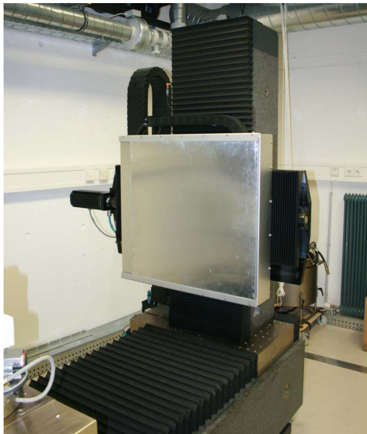
Abbildung 2.19: Darstellung eines „Flat panel detector“ eines industriellen Computertomographen mit offenem Aufbau (aktive Detektoroberfläche: 410 \times 410 \text{ mm}^2 ; 1024 \times 1024 \text{ Pixel} ).
