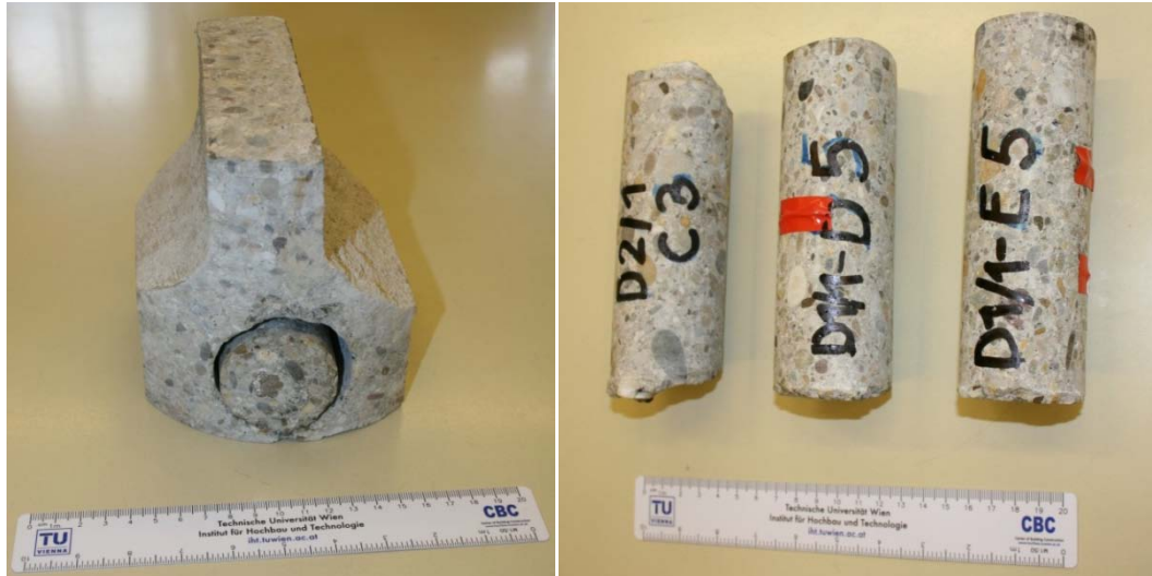
Abbildung 8.10: Entnahme der „kleinen“ Bohrkerne (H: 150 mm, Ø 50 mm)
