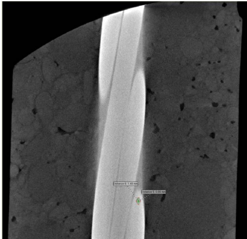
Abbildung 8.18: Schnittbild „von der Seite“ einer Korrosionsstelle der Probe D1-1/E5, mit Ausmaßen von 0,89*1,49 mm
