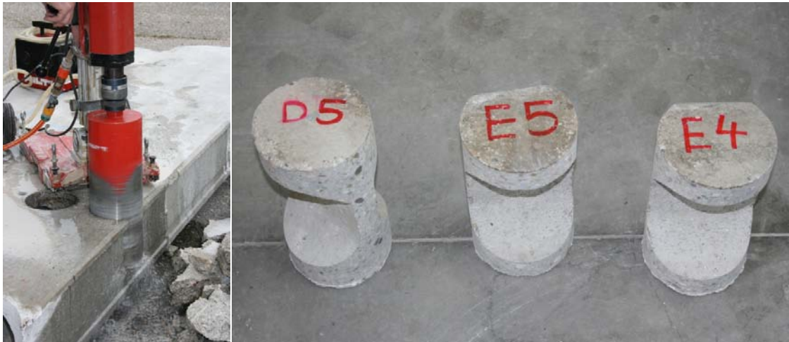
Abbildung 8.9: Probenentnahme für die Computertomographie mittels Kernbohrung ( \varnothing 150 mm)
