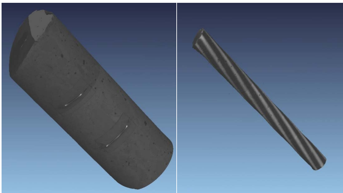
Abbildung 8.21: 3D-Darstellung der Probe D1-1/E5 nach dem Zusammenfügen der einzelnen Messbereiche; gesamte Probe (links) und Separation des Spannstahls (rechts), die dunklen Punkte am Spannstahl (rechts) sind einzelne Korrosionsstellen
