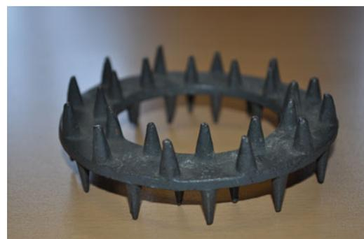
Abb. 34b: Ansichten des Dübeltyps C10 (abgenutztes Exemplar) nach System GEKA
