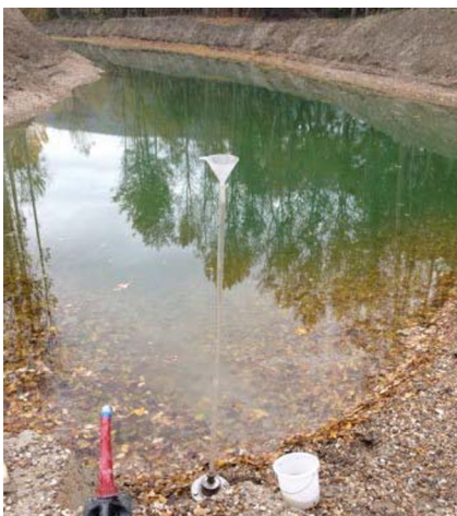
Abb. 10 Versickerungsversuche im Johler Arm im Jahr 2013
