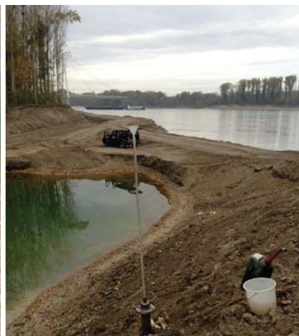
Abb. 10 Versickerungsversuche im Johler Arm im Jahr 2013
