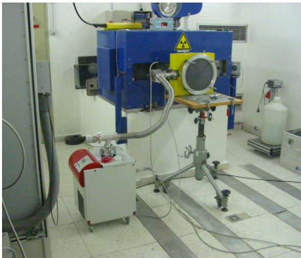
Abbildung 29: Messaufbau mit dem Graphit-Kalorimeter an der ^{60}\text{Co} Bestrahlungsanlage der PTB (linkes Bild) und Messanordnung für die Ionisationskammermessungen im Graphitphantom an der METAS ^{60}\text{Co} Bestrahlungsanlage (rechtes Bild)
