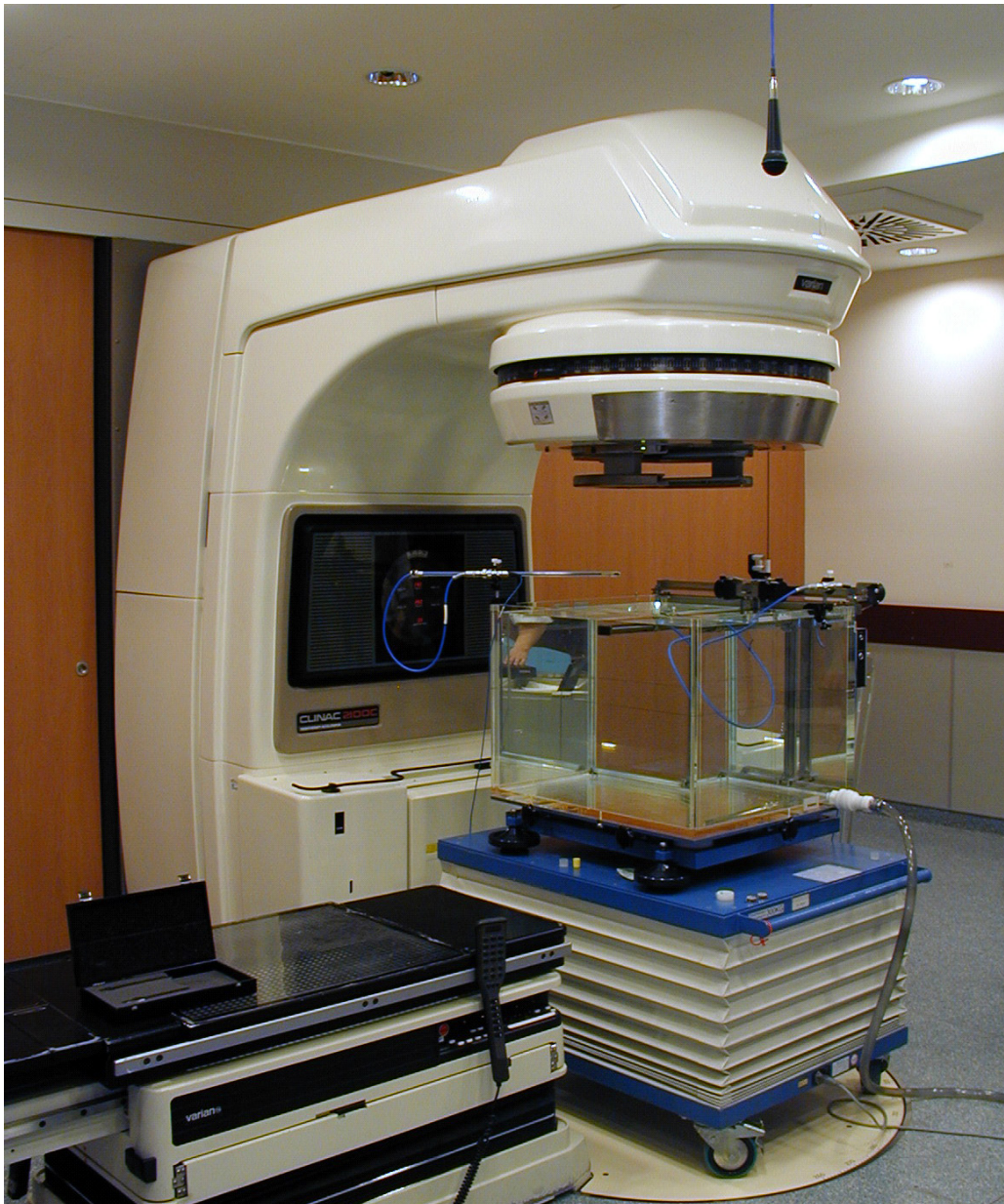
Abbildung 23: Messaufbau für die Bestimmung der Tiefendosiskurven im LK Wiener Neustadt
