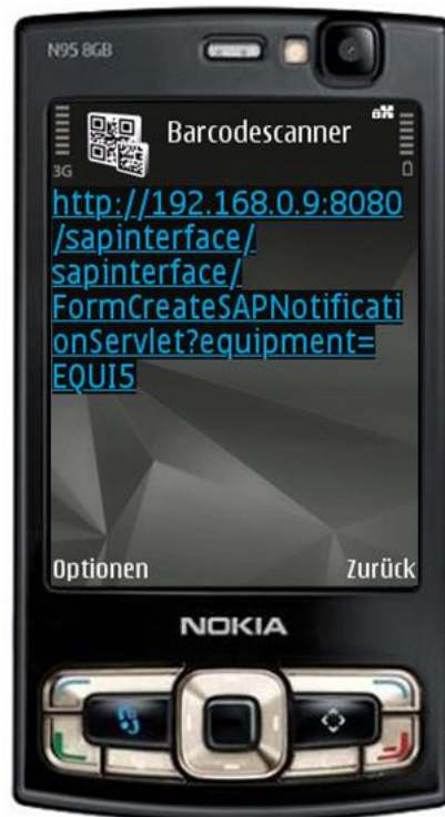
Abbildung 7.4: Data Matrix Barcode erfolgreich mit Barcodescanner am mobilen Endgerät Nokia N95 8GB eingelesen [Lad09]
