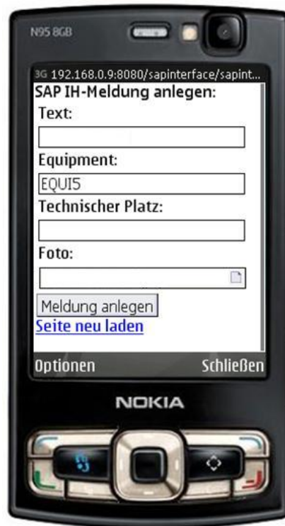
Abbildung 7.5: Automatische Befüllung des Eingabefeldes Equipment durch den Aufruf des Links aus dem Data Matrix Barcodescanner [Lad09]
