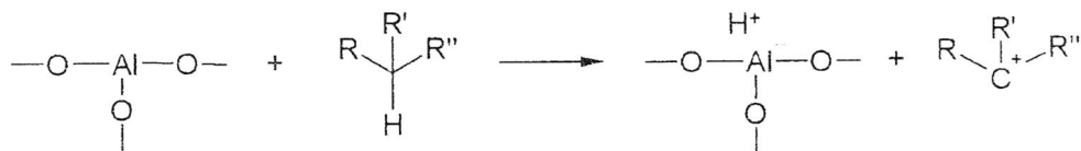
Bild 2.8: Bildung von Carbenium-Ionen an der Katalysatoroberfläche
