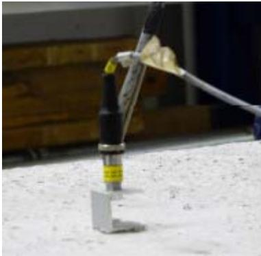
**Abbildung 4.7** Beschleunigungsaufnehmer
