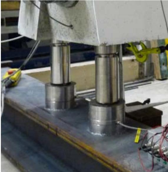
**Abbildung 4.5** Kraftmessdosen K1 und K2
