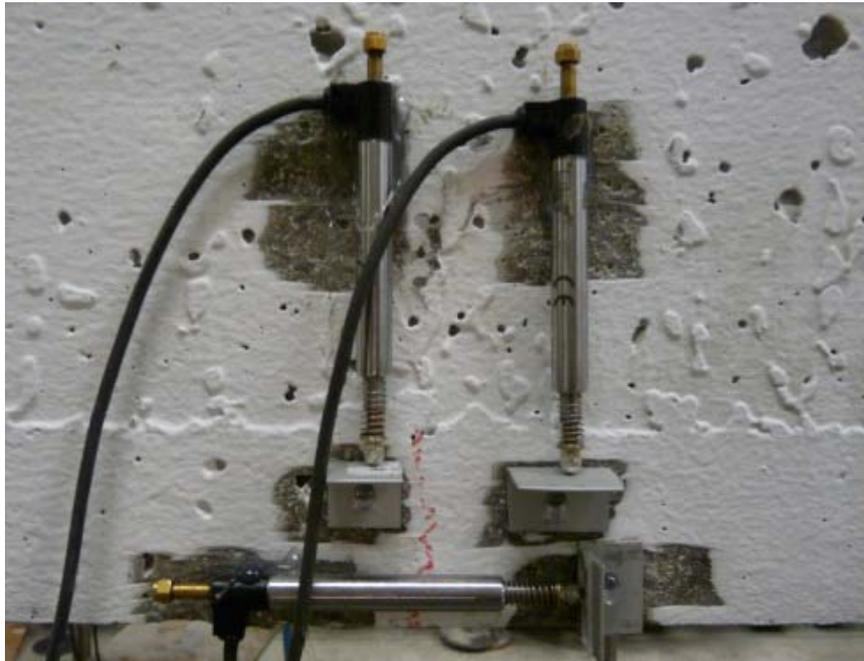
**Abbildung 4.6** induktive Wegaufnehmer (Wi1-Wi14)
