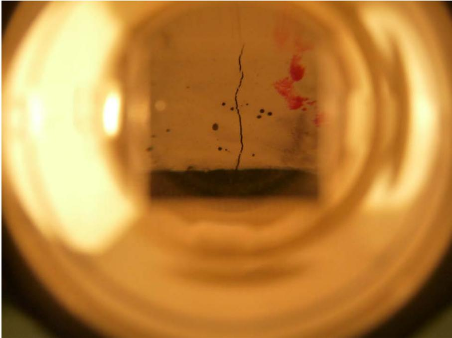
**Abbildung 7.11** Riss durch Risslupe
