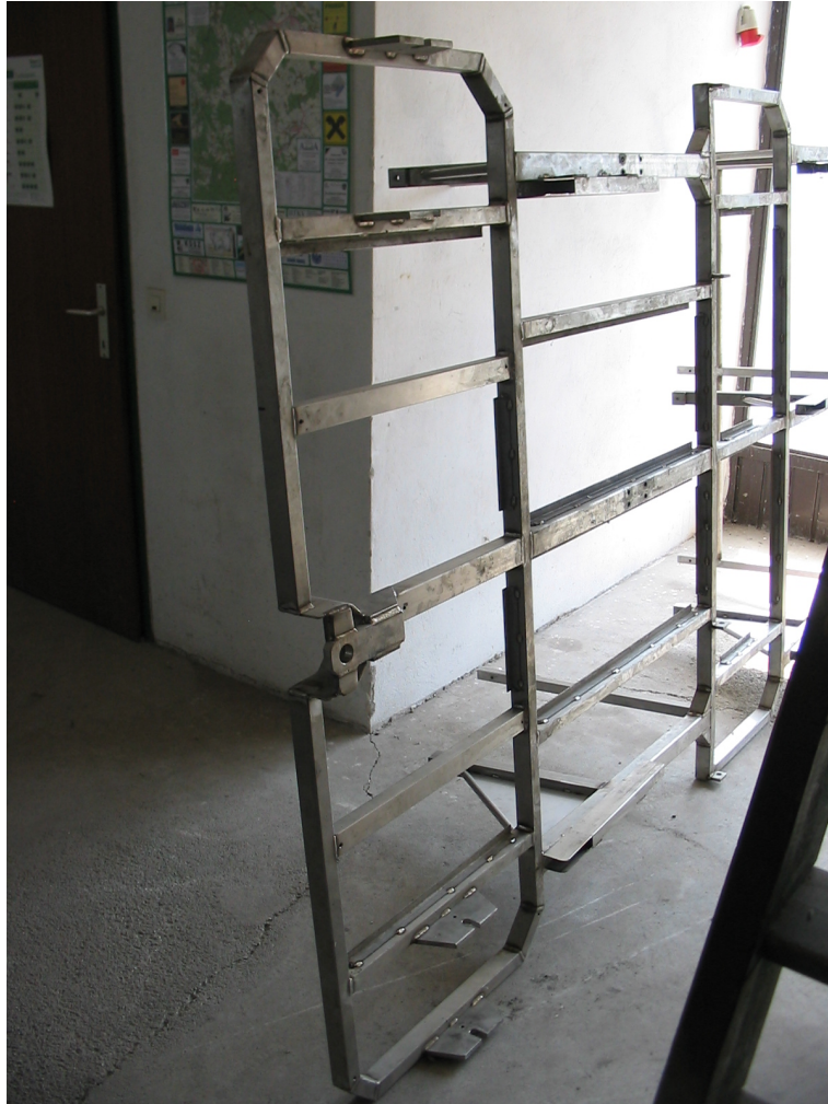
Abb. 4.1: Grundrahmen der Solardraisine mit Befestigungslaschen für die Achsen sowie Kettenschützer und Sattelstützen.
