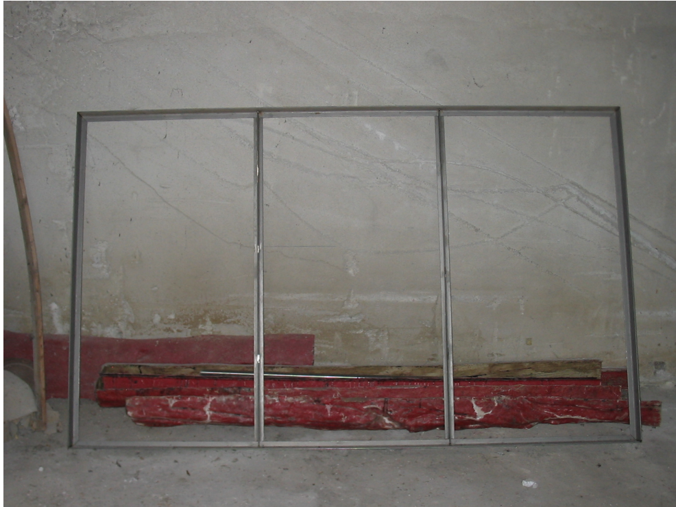
Abb. 4.2: Rahmenkonstruktion zur Aufnahme der drei Solarpaneele.
