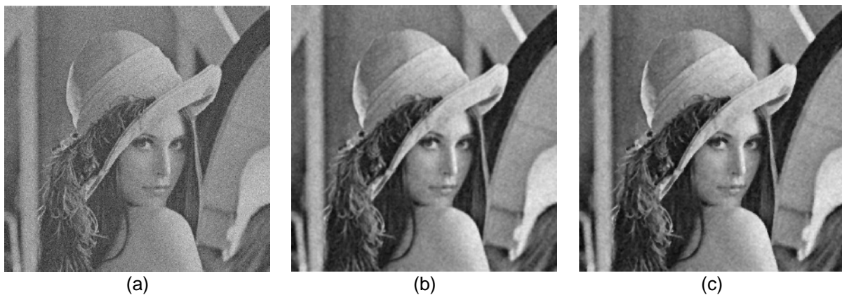
Abbildung 11: (a) Ausgangsbild, welches mit additivem Gaußschem Rauschen ( \sigma=30 ) verfälscht wurde. (b) Resultat des bilateralen Filters. (c) Ergebnis der doppelten bilateralen Filterung (Abbildung aus [27]).
